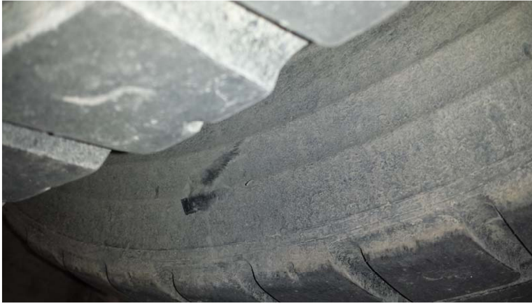
Trace de frottement sur le pneu arrière gauche : source CNESST
