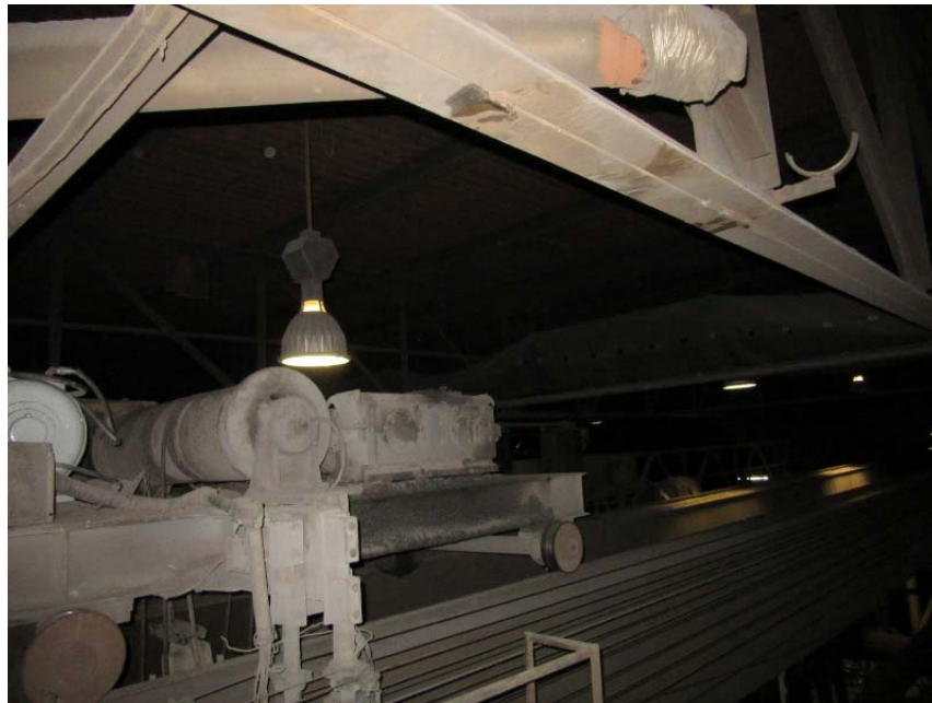
Photo 4 Des traces de frottement sous la poutrelle de toit
