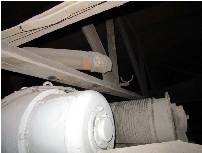
Photo 5 Distance de dégagement de 9 cm entre le Morris II et la poutrelle de toit
