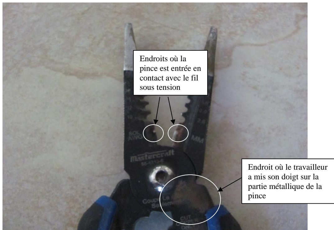
Photo 7 : Partie métallique des pinces du travailleur (Source : CNESST)
