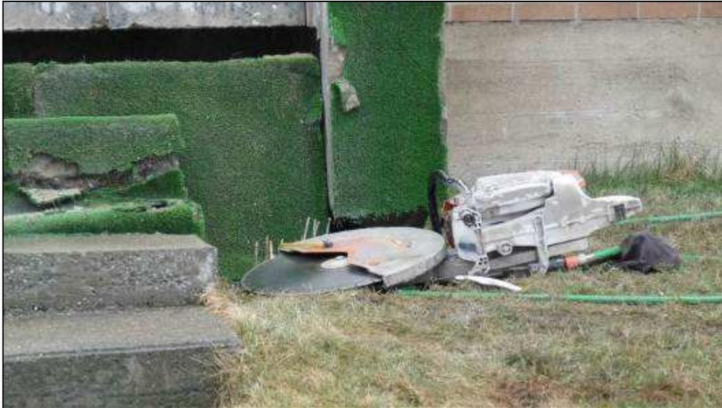
Photo 6 : Découpeuse à disque modifiée retrouvée sur le chantier
