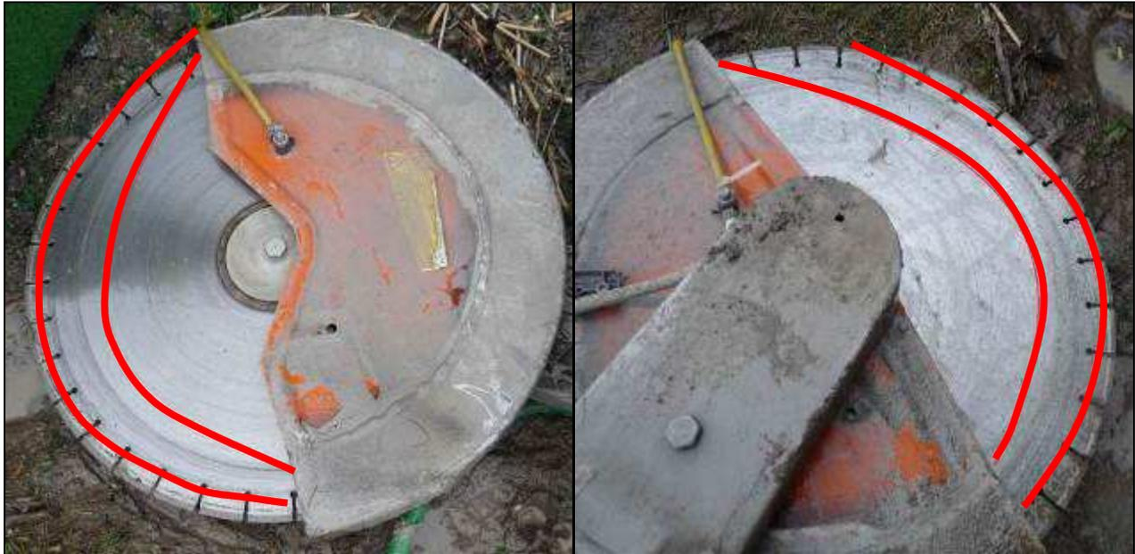
Photo 8 : Marques circulaires sur les deux faces du disque (à l'intérieur des lignes rouges)
