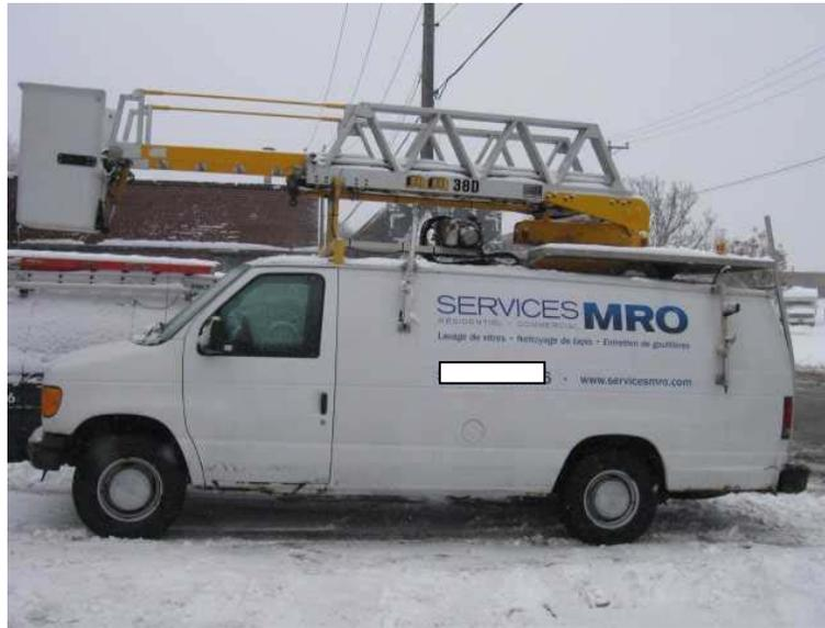
**Photo 3 :** Camion élévateur à nacelle (source : CSST)
