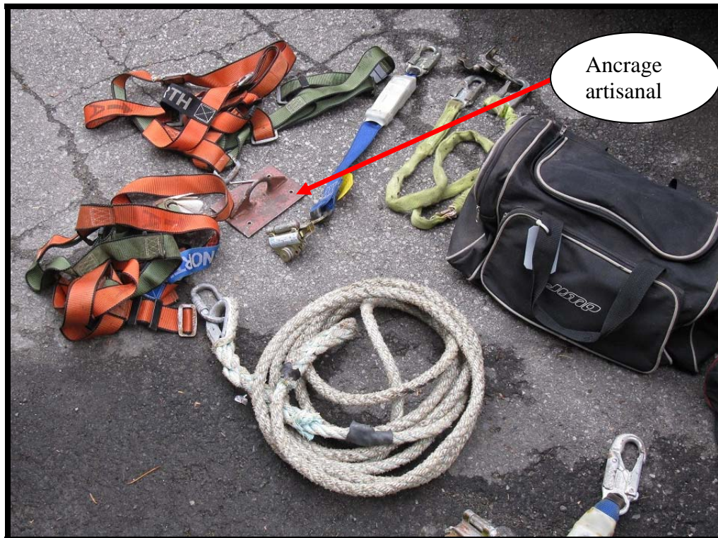
Photo 7 : Une partie des dispositifs d'arrêt de chute disponibles au chantier (source : CSST)
