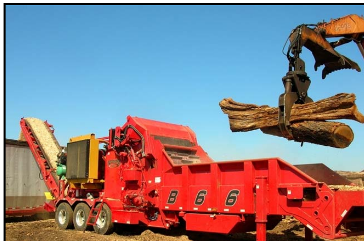
Photographie 3 : Déchiqueteur mobile Rotochopper B66 (Source : site Internet www.rotochopper.com )
