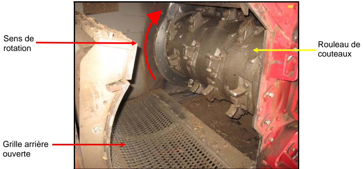
Photographie 6 : Arrière de la chambre de broyage (Source : CSST)
