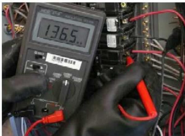
Photo 10 : fil rouge - phase incorrecte (pas bien isolée par rapport à la terre); c'est la phase qui était connectée à la borne G (« Ground ») de l'unité extérieure (thermopompe sur le toit de l'immeuble)
