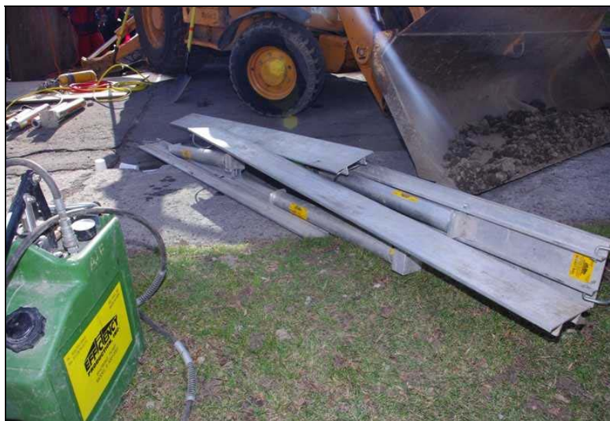
Photo 10 : Système d'étaionnement à l'extérieur de la tranchée
