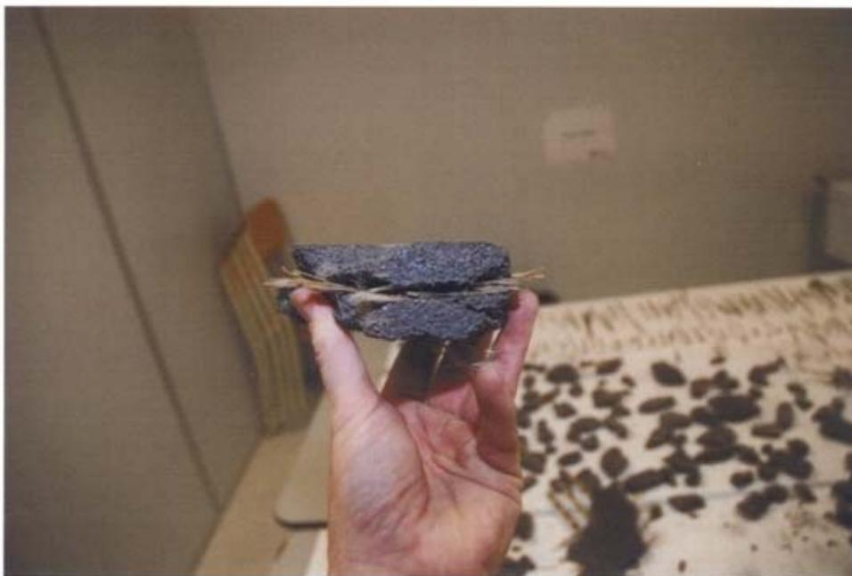
Photo 15 : Autre vue radiale d'un débris de la meule
