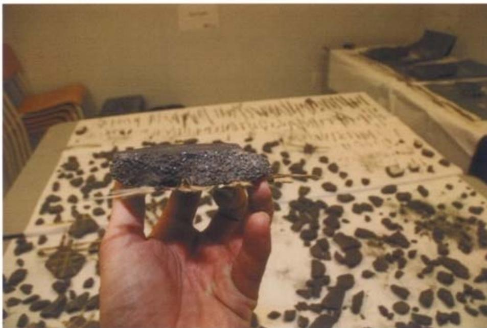
Photo 13 : Vue radiale d'un débris de meule
