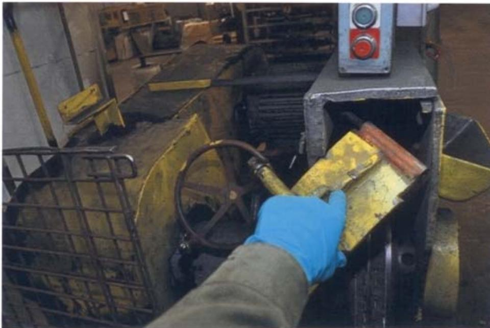
Photo 27 : Positionnement du garde de sécurité de la meuleuse après l'accident
