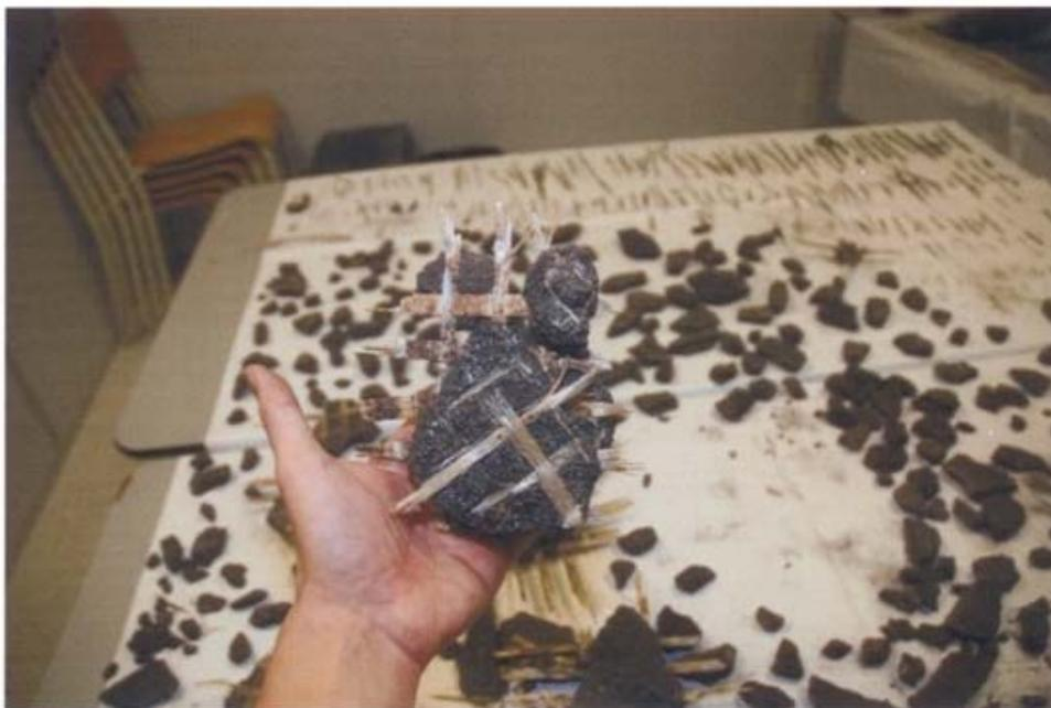
Photo 14 : Portion avec vue du treillis de fibre de verre d'un débris de la meule
