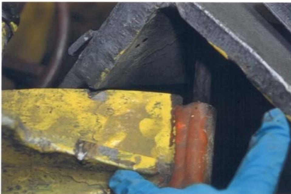
Photo 28 : Vue rapprochée de la position du garde de sécurité par rapport à la volute avant de la meuleuse
