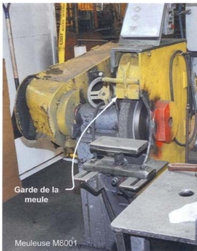
Photo 29 : Vue du garde de sécurité de la meule M8001; ce garde de sécurité est à la bonne position
