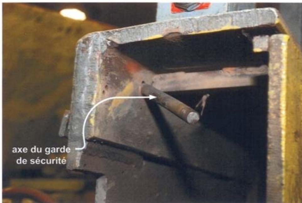
Photo 25 : Portion haute avant de la volute de la meuleuse; l'axe du garde de sécurité est tordu
