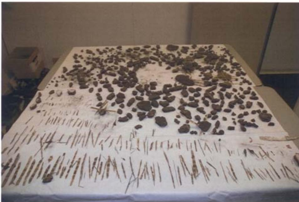
Photo 17 : Portions de treillis de fibre de verre recueillies parmi les débris
