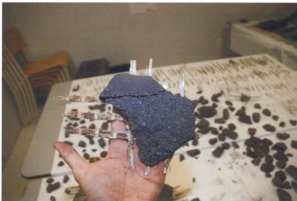
Photo 16 : Débris montrant une délamination
