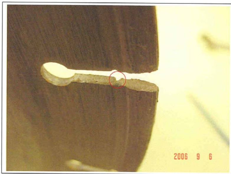
Photo 5. Entaille en plusieurs endroits en périphérie de la lame de scie.
