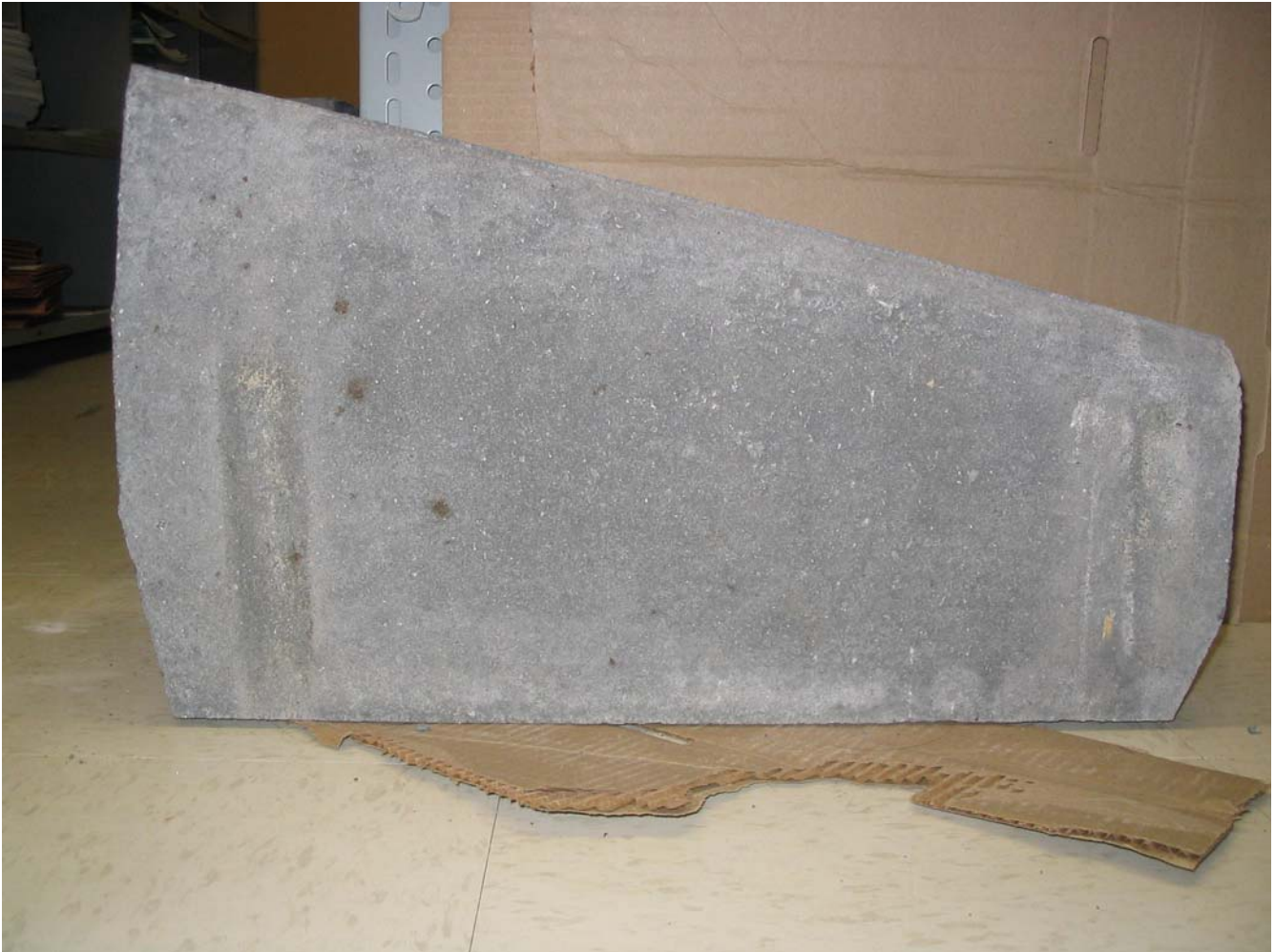
Photo 3: Bloc de bordure préfabriquée de transition (Source: CSST)
