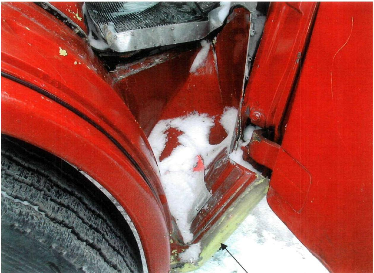
Photo #3 : Marchepied de la porte du côté passager plié suite à la collision.
