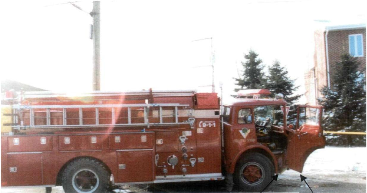
Photo #1 : État de la porte et du marchepied de la porte du côté passager suite à la collision.
