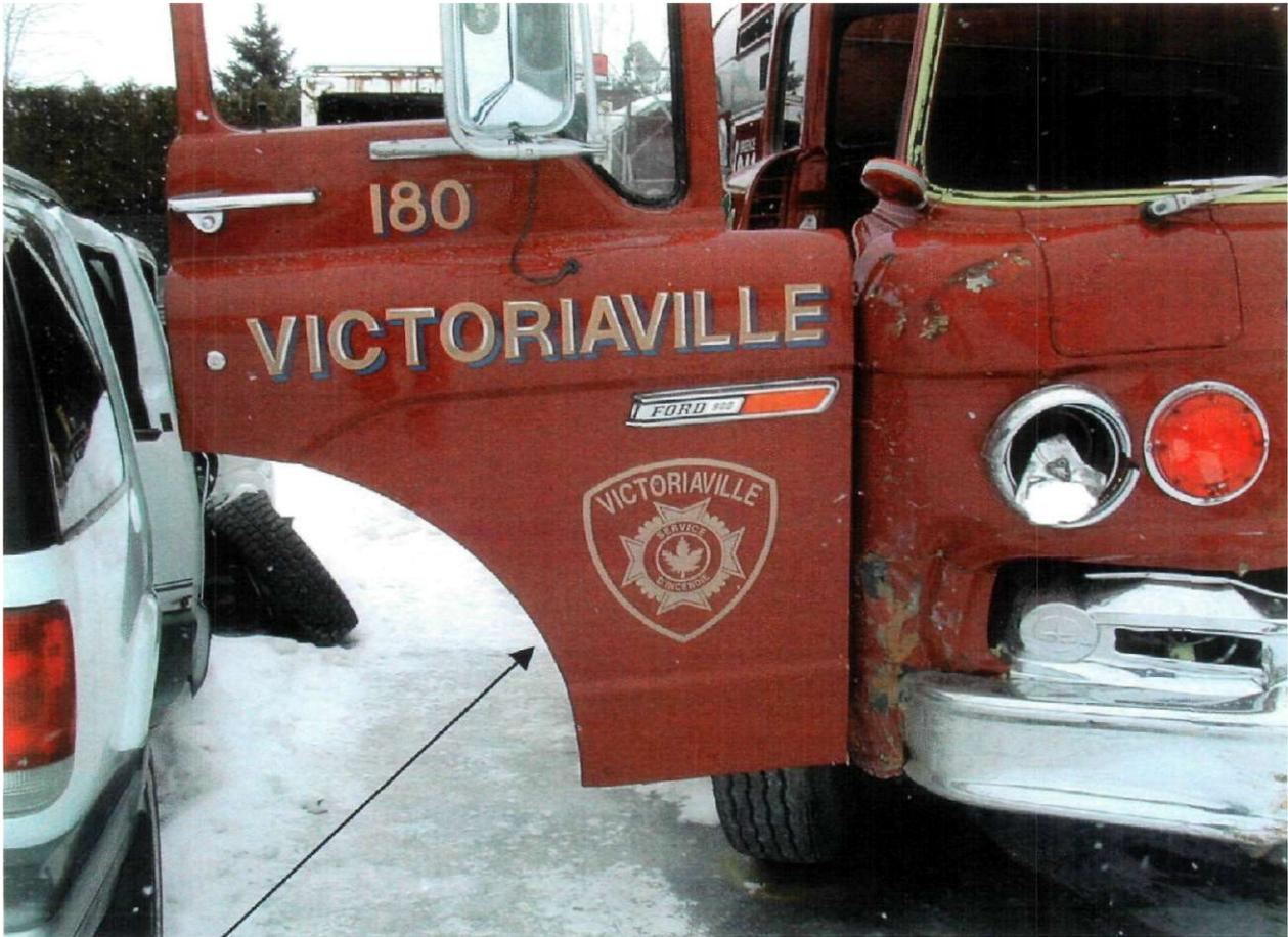
Photo #2 : État de la porte du côté passager suite à la collision.
