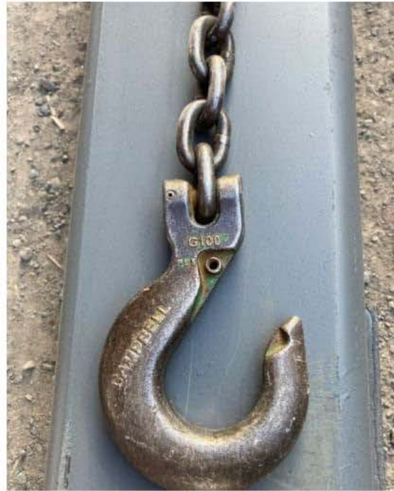
Fig. 8 - Crochet de l'élingue de chaîne utilisé pour déplacer le paquet de contreventements Source : CNESST
