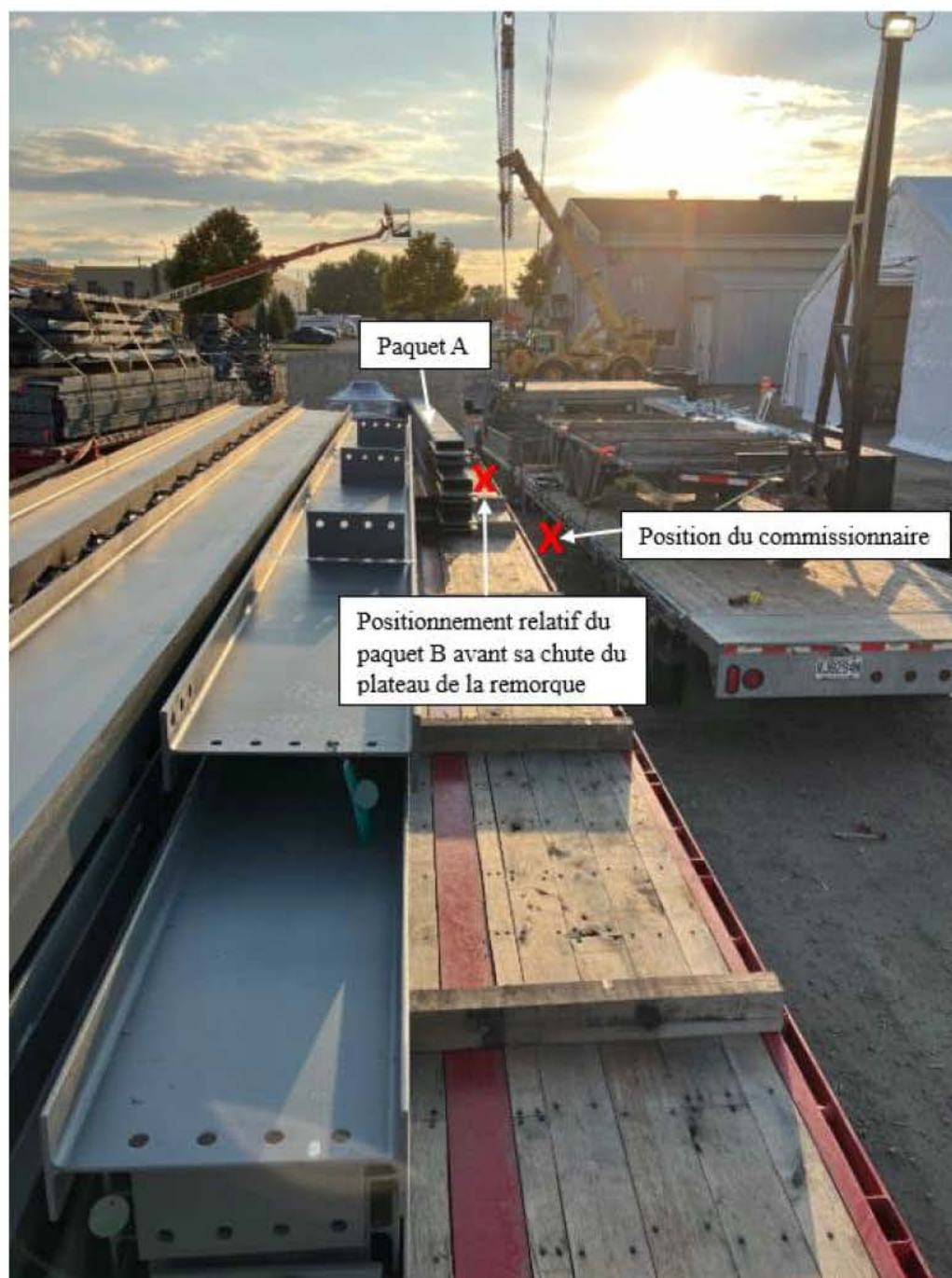
Fig. 6 - Positionnement du chargement avant la chute du paquet de contreventements B
