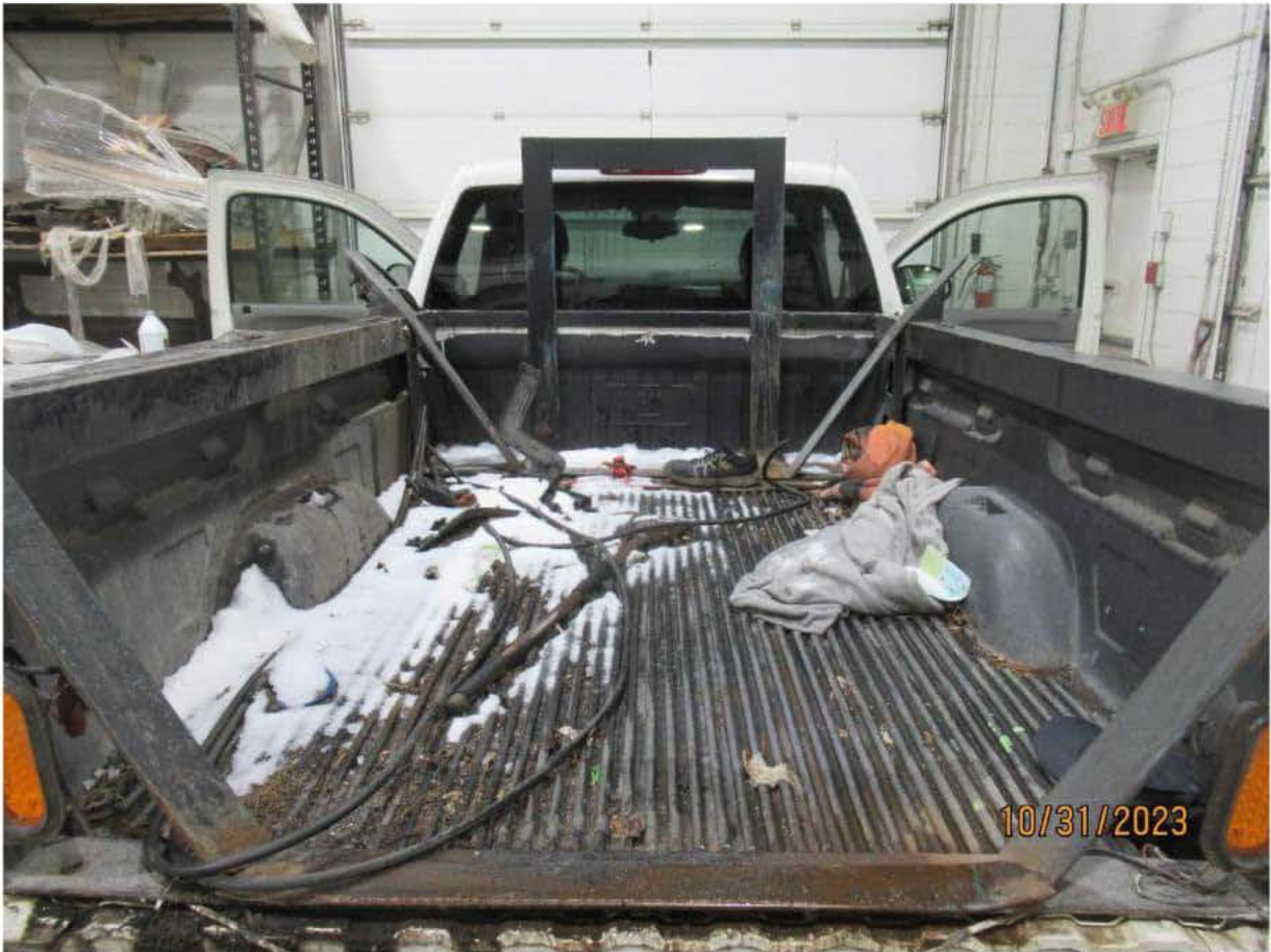
Photo 6 : Support de la benne et boyaux hydrauliques du verseur
