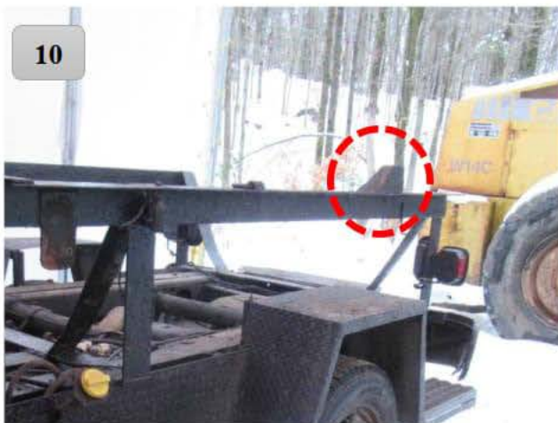
Photos 10 & 11 : Butée et fer-angle provenant d'une autre camionnette
