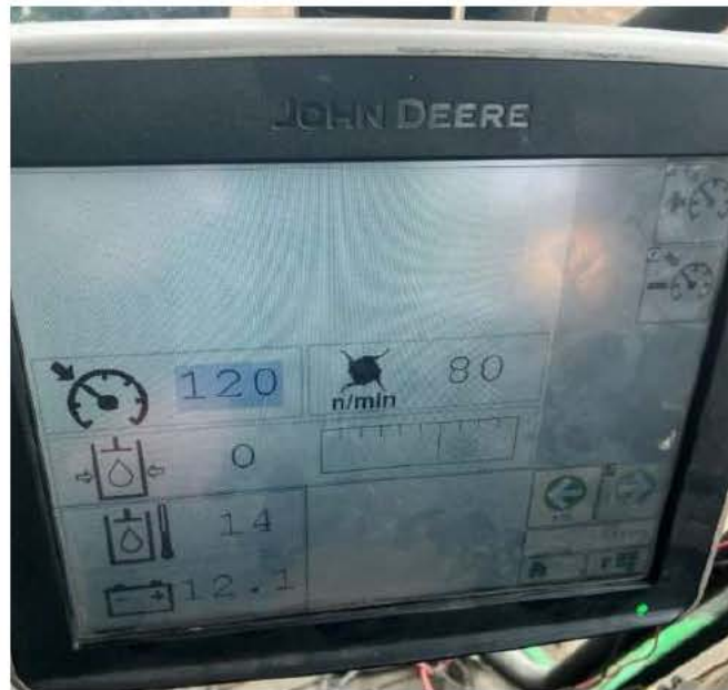
Fig. 4 - Écran de contrôle de l'interface ISOBUS dans la cabine du tracteur John Deere Source : CNESST
