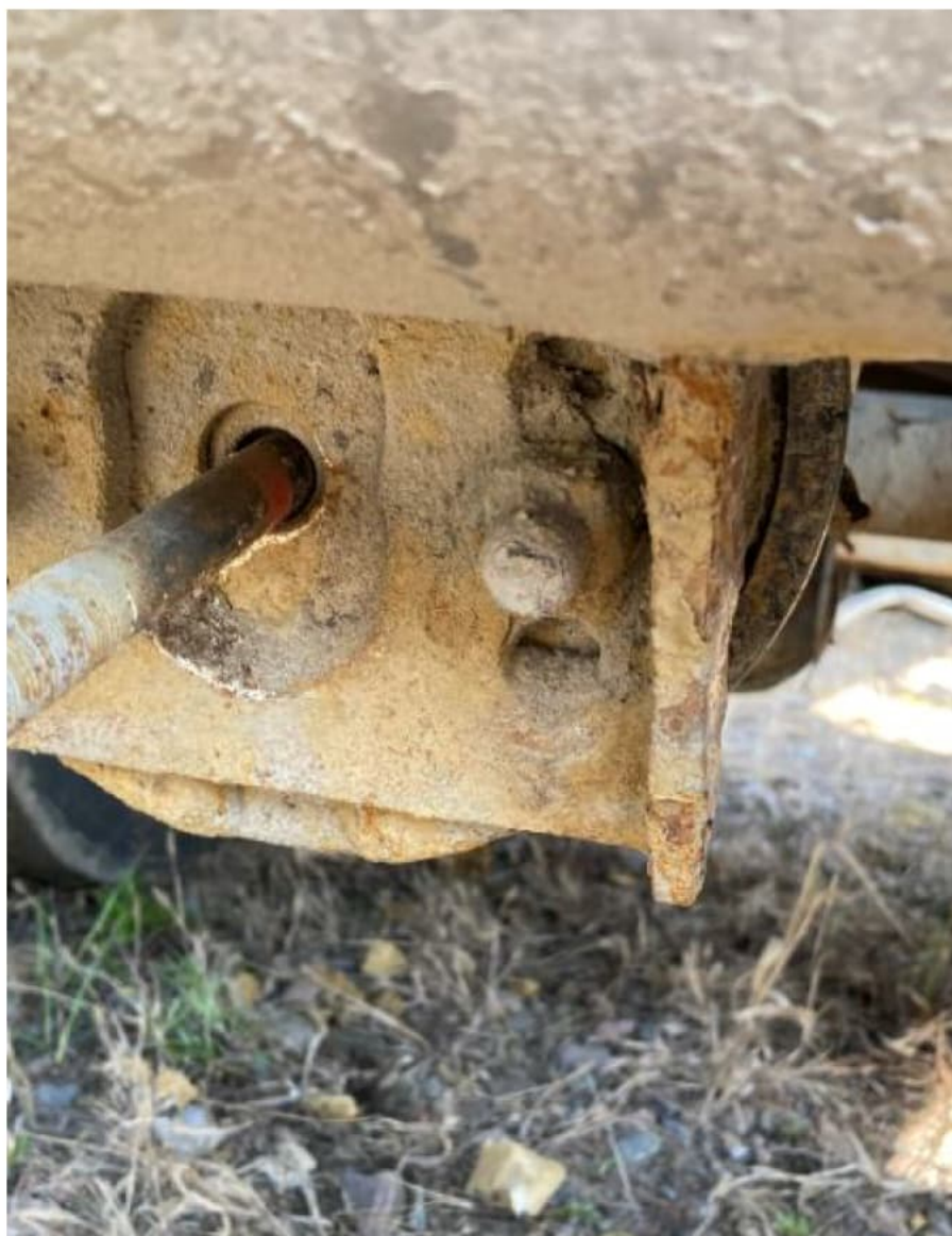
Fig. 11 Indicateur rouge sur une tige de poussée de la semi-remorque
