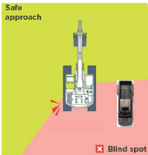
Fig. 5 - Angle mort excavatrice Source : Image Web, modifiée CNESST
