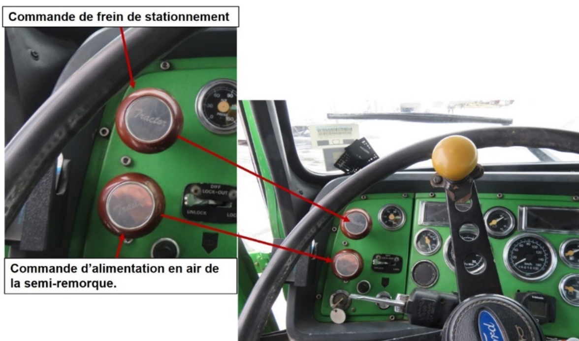
Figure 16 — Commande de frein de stationnement et d'alimentation en air de la semi-remorque
