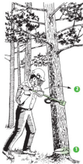
Image 4 : Utilisation d'un outil pour abattre un arbre encroué Source : Guide de la CNESST « Abattage manuel – 2 e édition »
