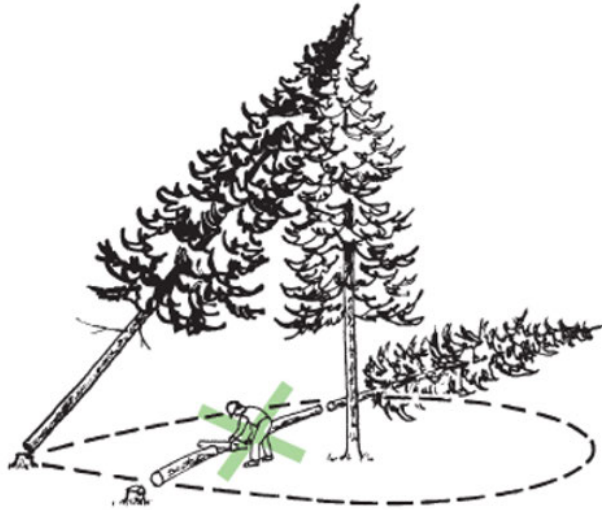
Image 3 : Travailleur dans la zone de chute possible d'un arbre encroué Source : Guide de la CNESST « Abattage manuel – 2 e édition »
