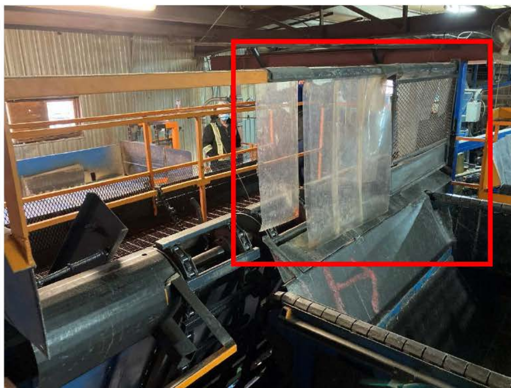
Photo 6 : écran suspendu (source : CNESST)
