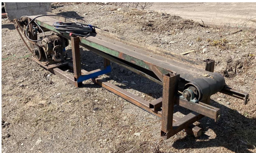
Photo 2 : convoyeur petite courroie démonté (source : CNESST)
