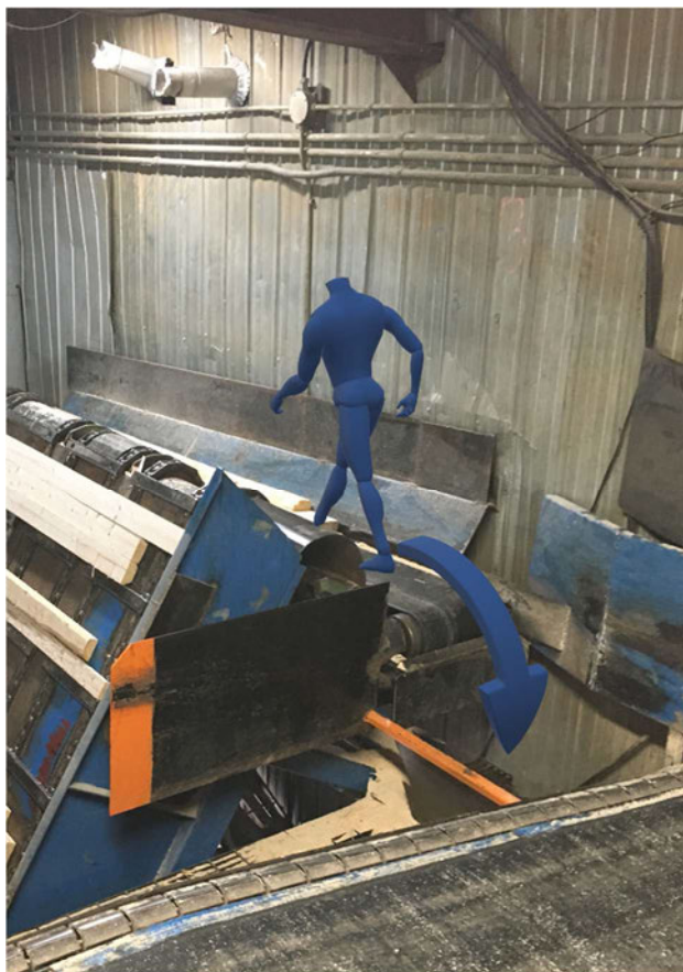
Photo 1 : représentation de l'accident (source : Groupe Lebel inc., modifiée par CNESST)
