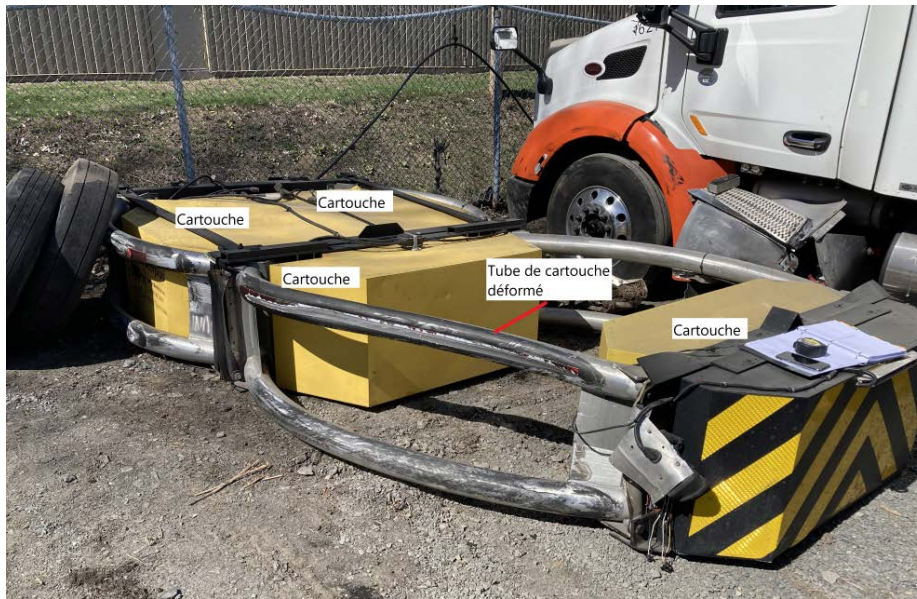
Figure 11 : AIFV découpé du camion après le remorquage Source : CNESST
