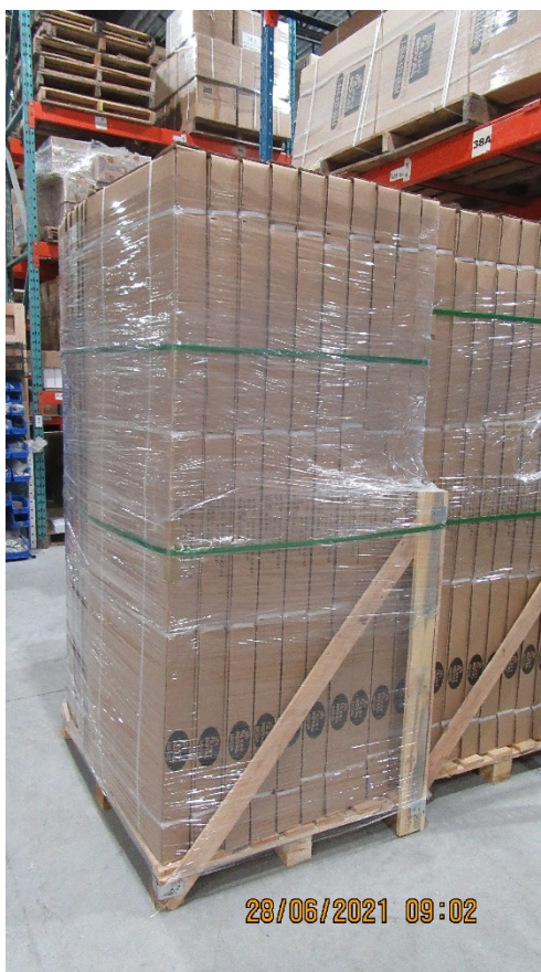
Photo 7 : Palettes à renforts contenant des boîtes de portes de douche et des boîtes de panneau fixe à la réception du fournisseur
