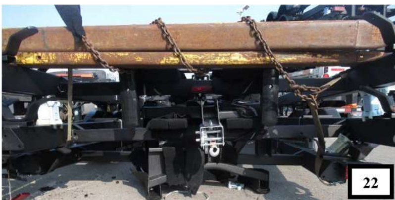
Photos 22 et 23 : Chaîne enroulée autour des rallonges de fourches du chariot élévateur Komatsu Source : CNESST
