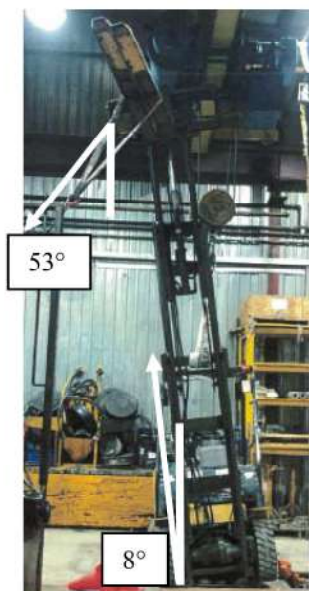
Photos 26 : Chariot élévateur Komatsu dont le mât est incliné de 8° Source : Vallée inc.
