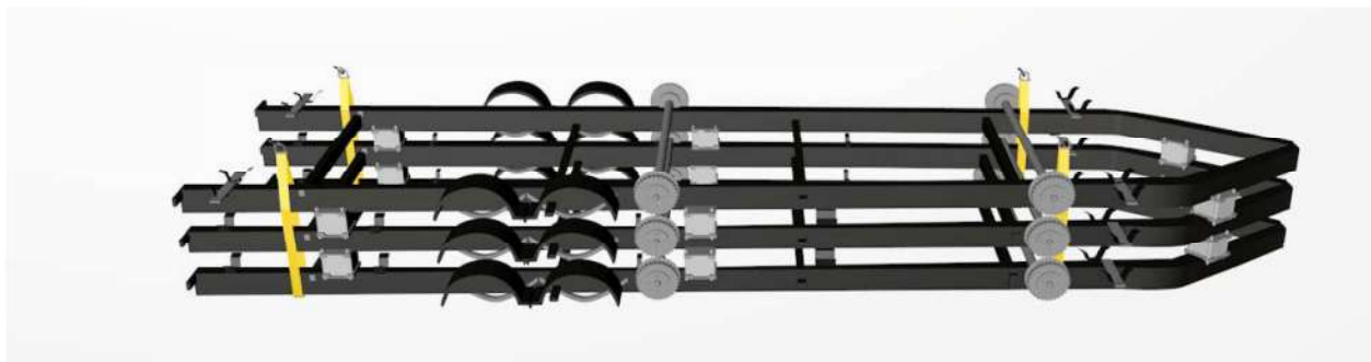
Dessin 1 : Élingues de nylon en panier sur les châssis
