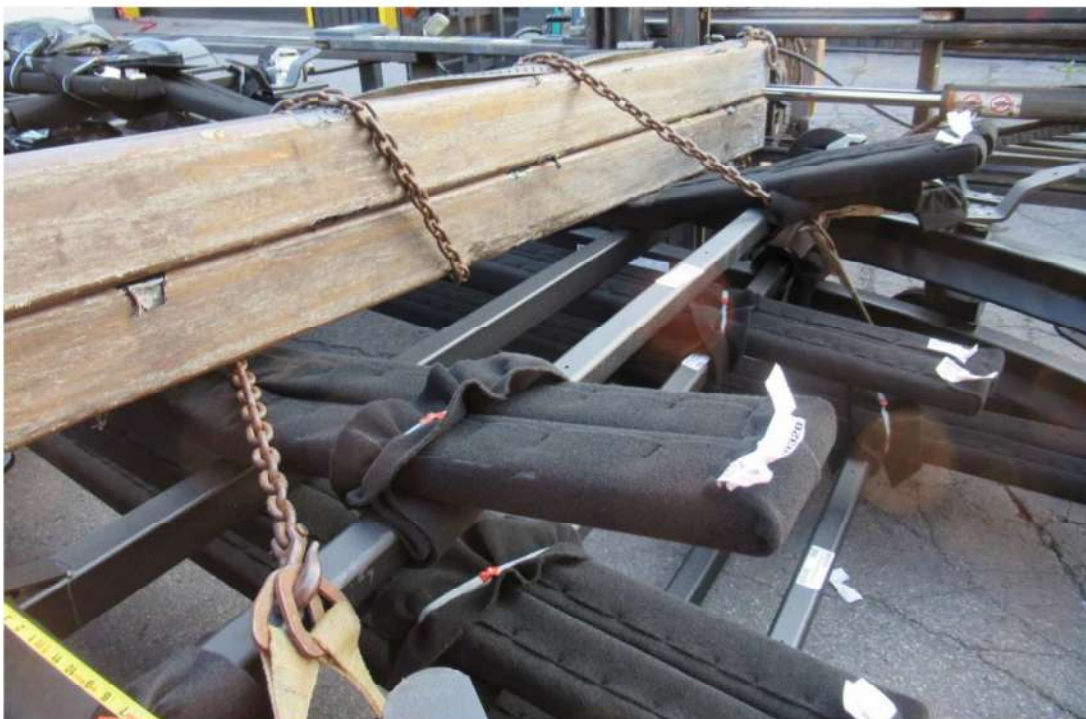
Photo 21 : Chaîne enroulée autour des rallonges de fourches du chariot élévateur Kubota Source : CNESST
