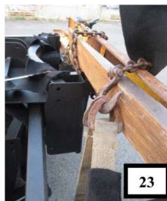
Photos 22 et 23 : Chaîne enroulée autour des rallonges de fourches du chariot élévateur Komatsu Source : CNESST
