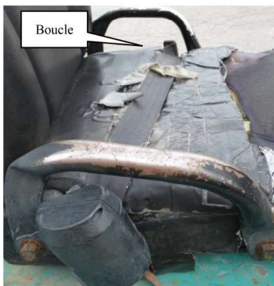
Photo 16 : Ceinture de sécurité du chariot élévateur Komatsu lors de l'accident Source : CNESST
