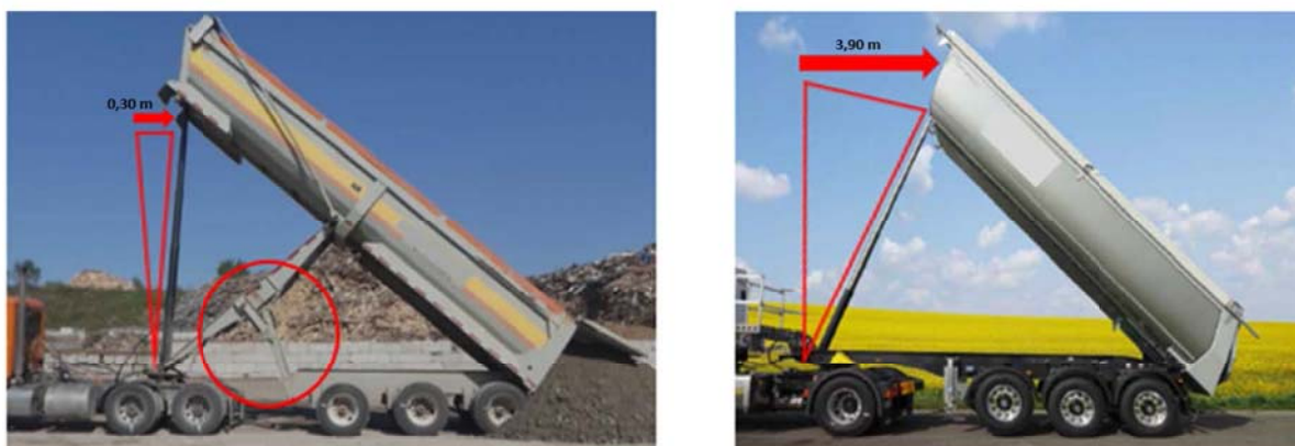
Figure 7 : Semi-remorque à benne basculante hybride (à gauche) et semi-remorque à benne basculante conventionnelle (à droite)
