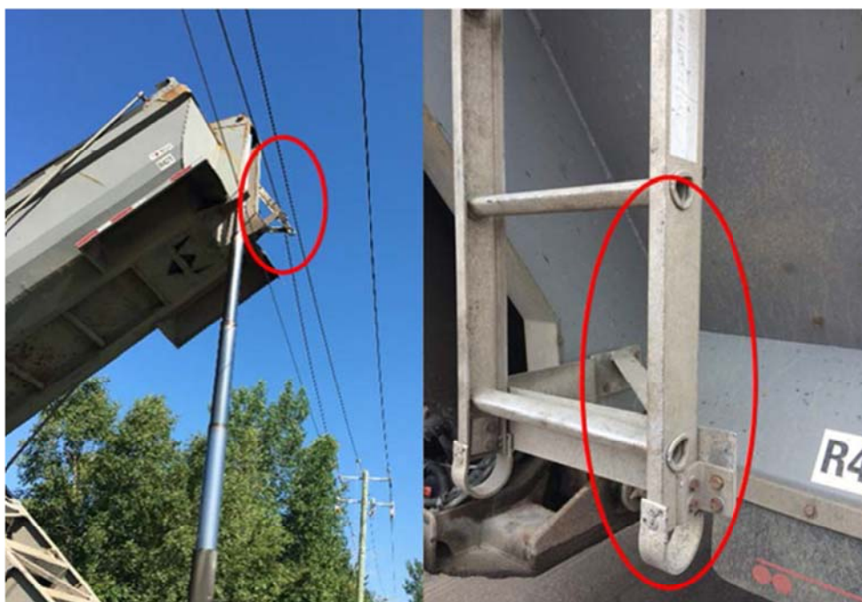
Figure 8 : Zone de contact entre l'échelle de la benne et le fil sous tension (Source : CNESST)
