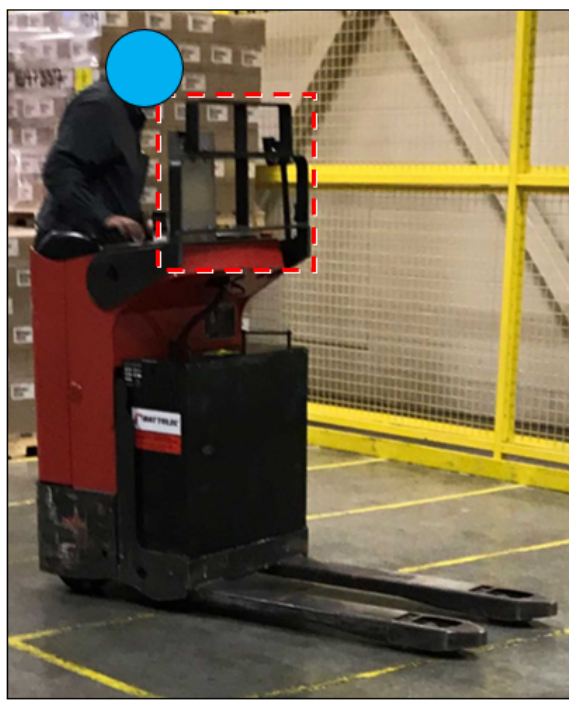
Figure n° 11 : Transpalette n° 144 équipé du dossieret de charge du fournisseur et de la rallonge de dossieret (Source : CNESST)
