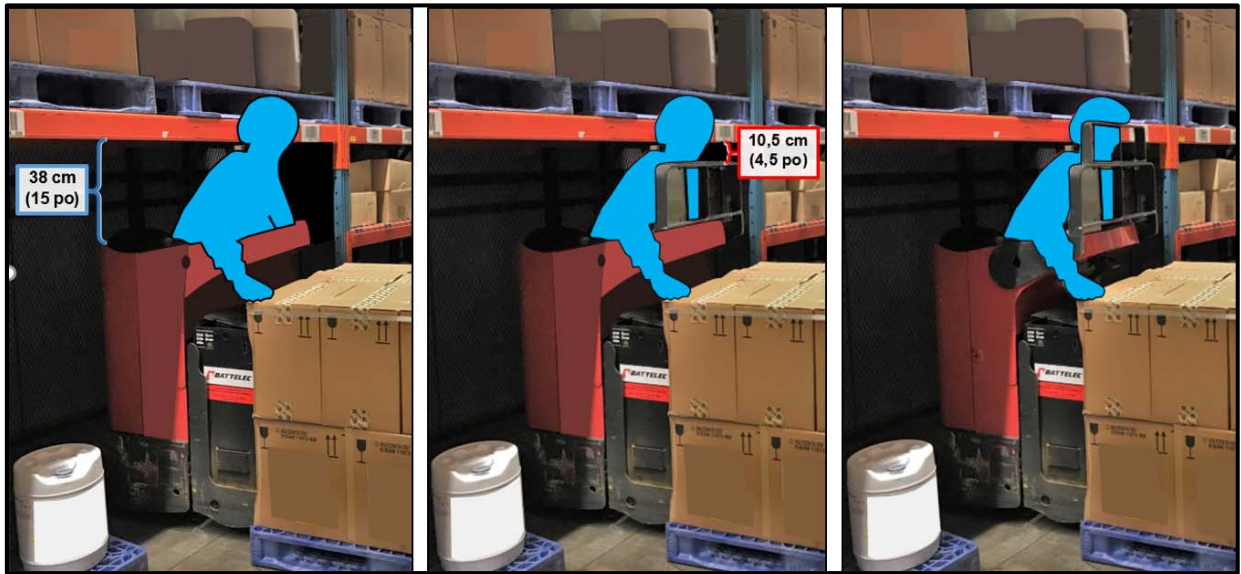
Figure n° 12 : Représentation de l'espace de dégagement entre la lisse inférieure des palettiers et le transpalette avant modification ( figure de gauche ), suivant l'ajout du dosseret de charge ( figure du centre ) puis l'ajout de la rallonge de dosseret ( figure de droite )
