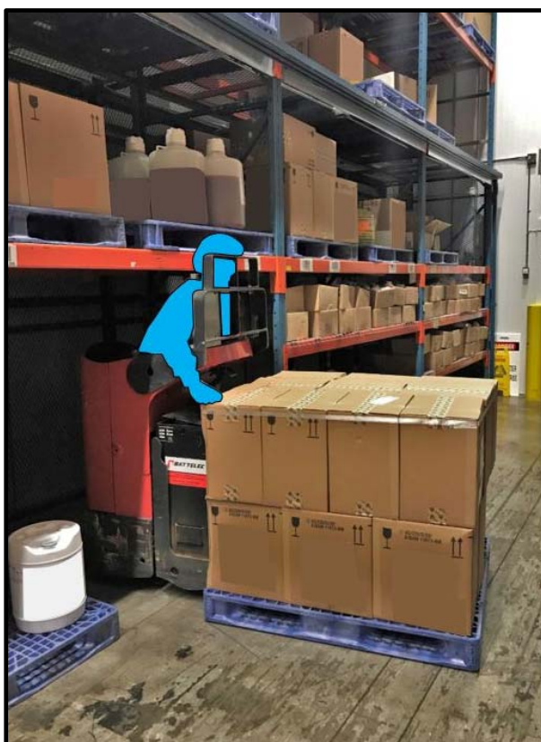
Figure n° 1 : Écrasement de la tête de l'opératrice entre la lisse du palettier et le dossier de charge du transpalette (Source : CNESST)
