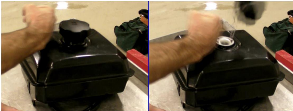
Figure 15 – Images extraites de la vidéo du test d'éjection du bouchon avec une pression dans le réservoir de 4,5 lb/po 2 .
