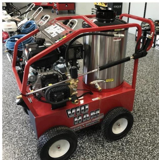
Figure 1 – Unité de lavage à pression identique à celles installées dans le camion cube Photo : CNESST
