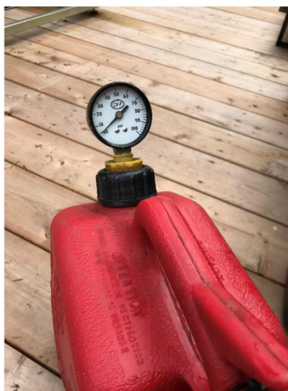
Figure 9 – Montage utilisé pour les essais de pression de vapeur réelle en contenant hermétique
