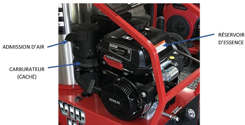
Figure 2 – Gros plan du moteur Kohler CH440 (côté face au mur de la boîte du camion cube)
