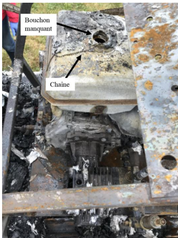
Figure 8 : Bouchon manquant et chaîne à l'extérieur (Source : CNESST)
