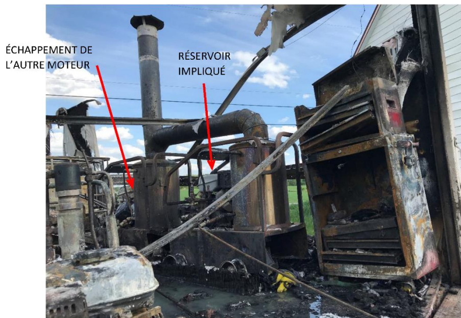
Figure 11 – Emplacement des deux unités de lavage à pression constaté après l'incendie. Photo : CNESST
