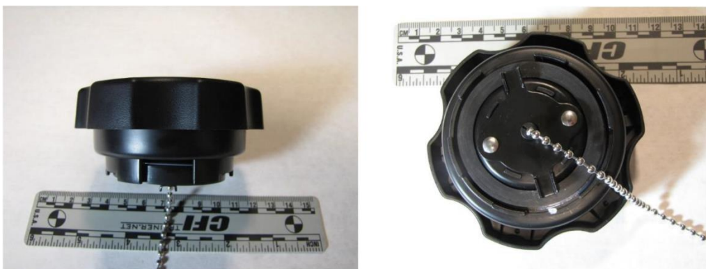
Figure 5 – Bouchon du réservoir d'essence vu de côté (à gauche) et vu de dessous (à droite)
