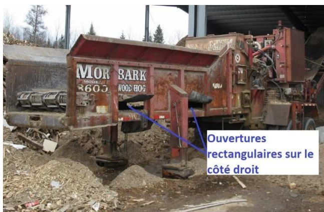
Photos 10 et 11 : Ouvertures rectangulaires sur les côtés gauche et droit Source : CNESST
