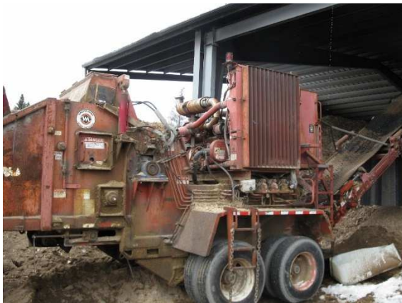
Photo 18 : Accès sur le dessus du broyeur Source : CNESST
