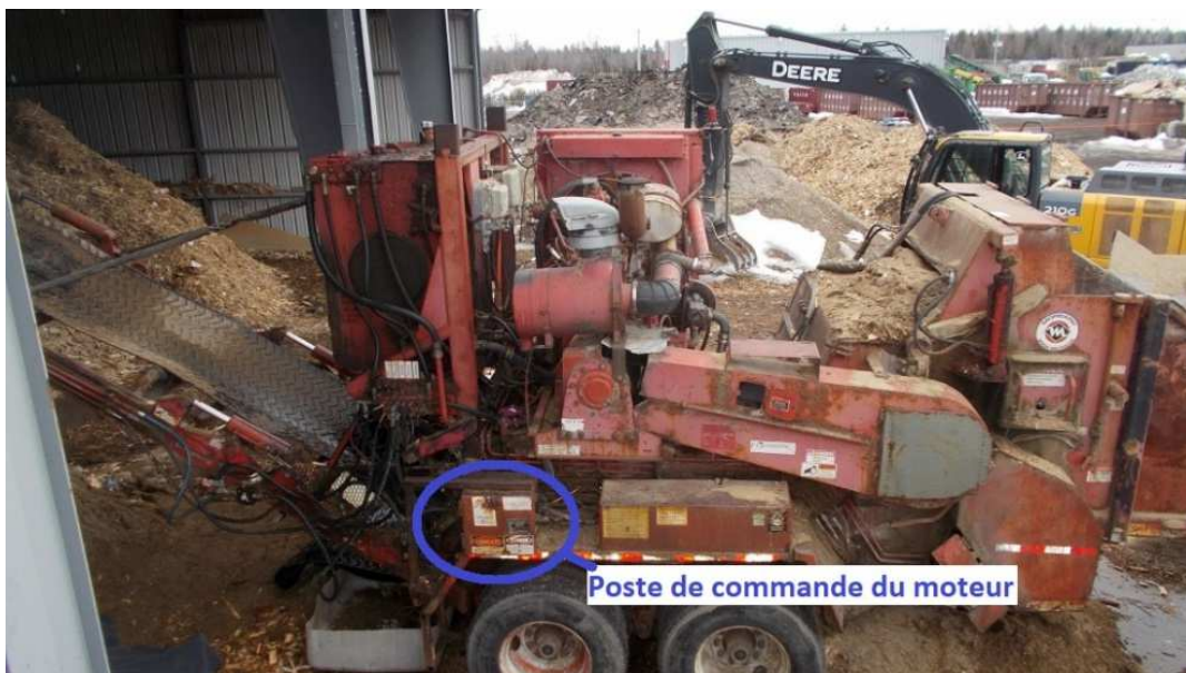
Photo 3 : Poste de commande du moteur du broyeur Source : CNESST
