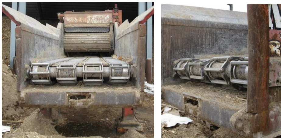
Photos 15 et 16 : Convoyeurs à chaînes accessibles derrière la trémie Source : CNESST
