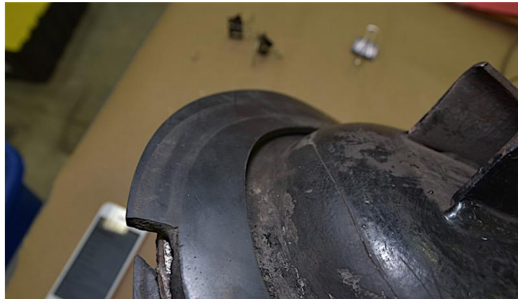
Vue rapprochée du couvercle et de son joint d'étanchéité
