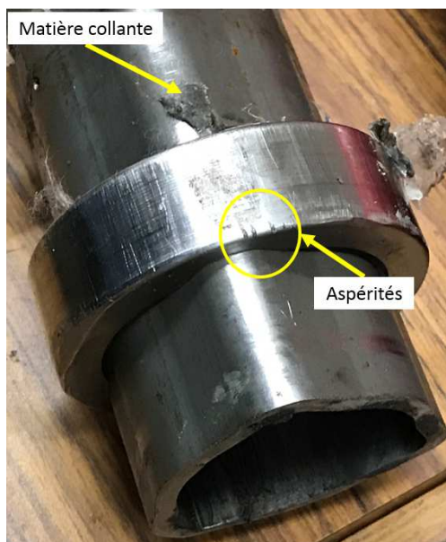
Figure 18 : Aspérités et matière collante de l'arbre de transmission (Source : CNESST)
