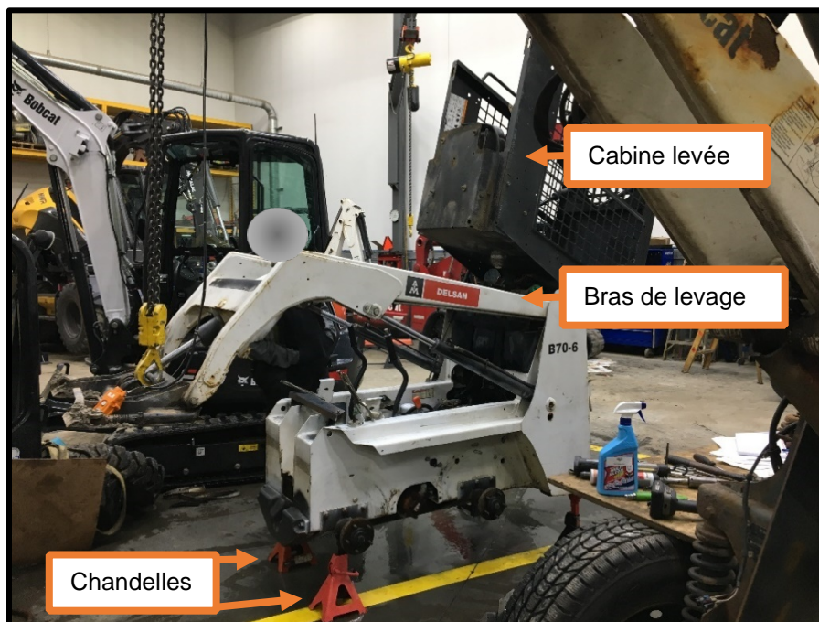
Photo 1: La chargeuse compacte Bobcat modèle S70 portant le numéro de série [...], tel que retrouvée suite à l'accident (Source : CNESST)
