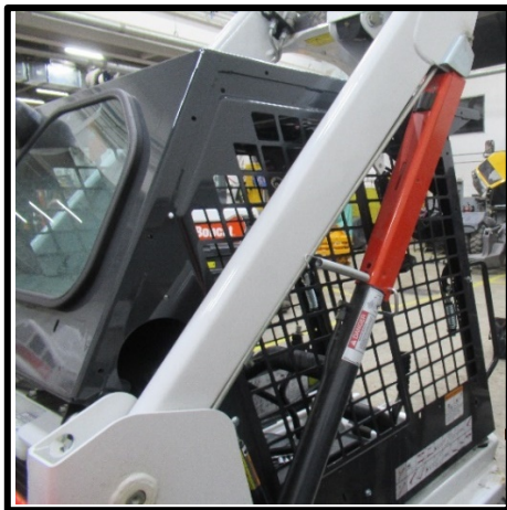
Photo 6 : Un arrêtoir d'origine vue de côté (Source : CNESST)
