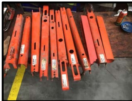
Photo 4 : Arrêteurs usagés conservés par l'employeur (Source : Employeur)
