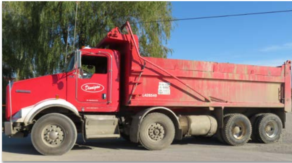
Figure 4 : Camion à benne basculante Source : CNESST
