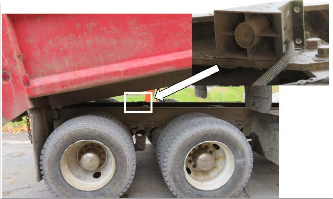
Figure 8 : Alarme de recul Source : CNESST, modifiée par la CNESST
