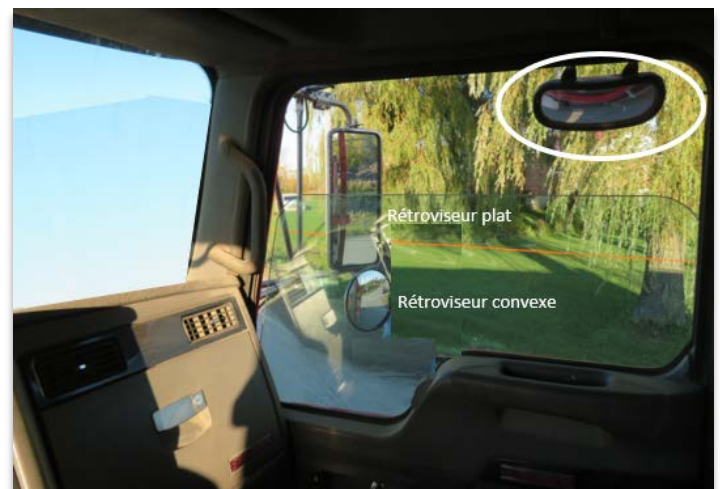
Figure 6 : Rétroviseurs côté droit Source : CNESST, modifiée par la CNESST
