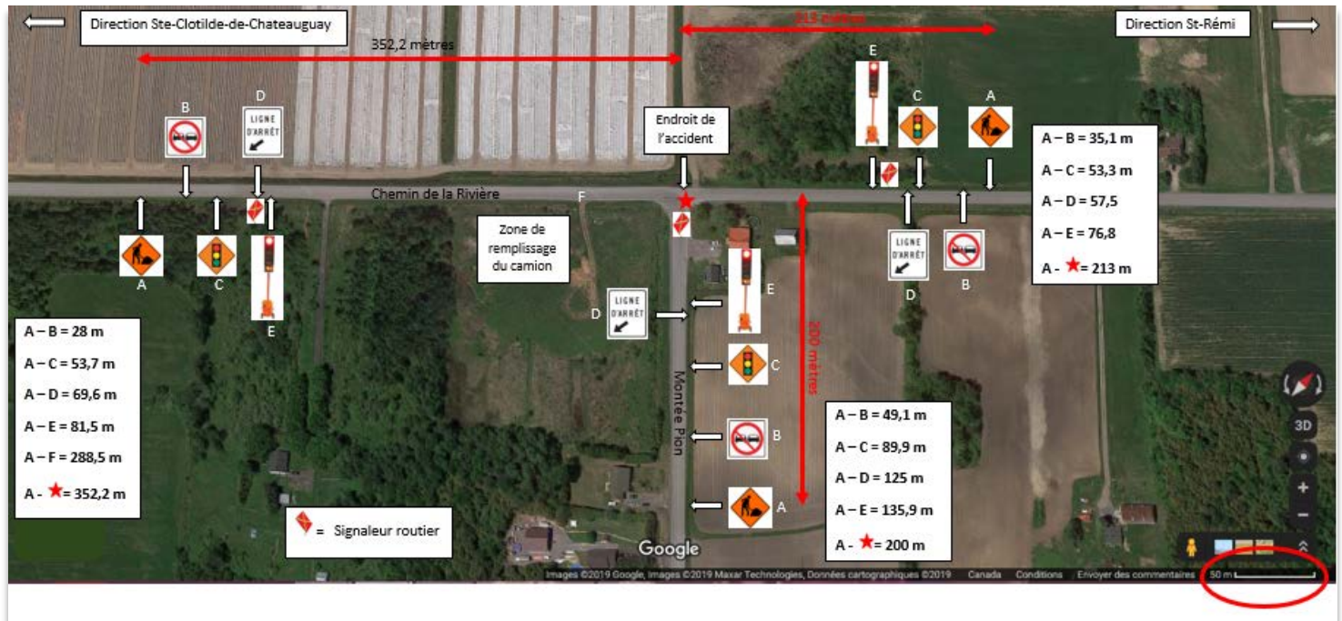
Figure 12 : Signalisation présente au chantier le 9 octobre 2019 et emplacement des signaleurs au moment de l'accident.
