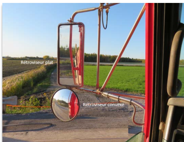
Figure 5 : Rétroviseurs côté gauche Source : CNESST, modifiée par la CNESST
