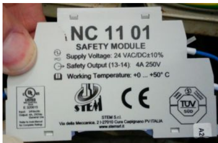
Photo 9: module de sécurité de catégorie 1 Photos 10 et 11: capteur électromagnétique codé
