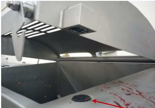
Photo 6: capteur d'interverrouillage (avec porte ouverte).
