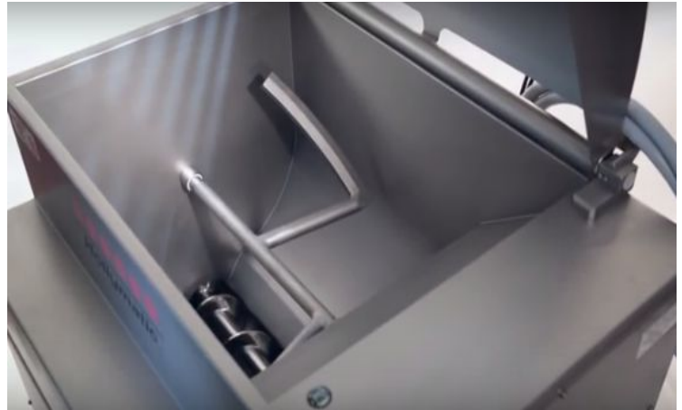
Photo 3: vue interne de la cuve de la machine où l'on peut distinguer la section « MIXER » en haut puis la section « FEEDER » au bas de la cuve.
