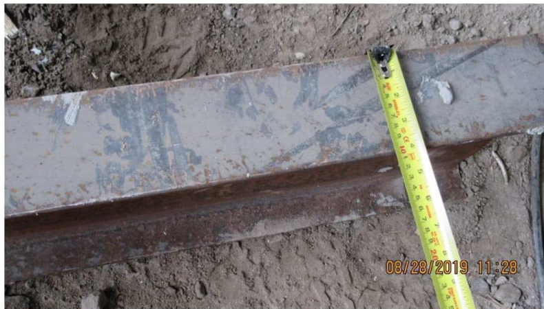
Figure 6.11 : Largeur de l'aile de 102 mm de la section W250x28 (versus 146 mm pour la section W250x33) 16
