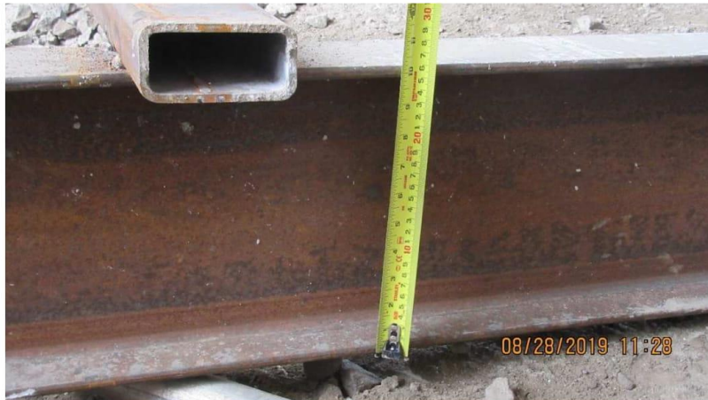
Figure 6.10 : Poutre W250x28 d'une hauteur de 260 mm 15
