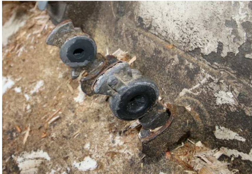
Figure 14 : Têtes d'accouplement des freins de la semi-remorque (Source : CNESST)
