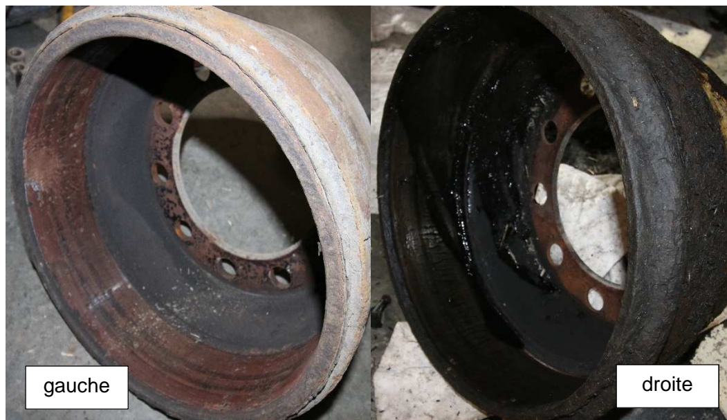
Figure 10 : Tambours de freins de l'essieu de direction (Source : CNESST)
