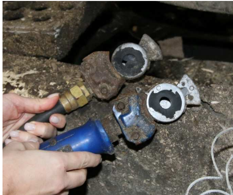
Figure 11 : Têtes d'accouplement des freins, côté camion (Source : CNESST)
