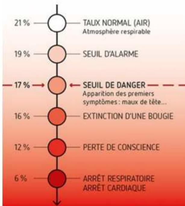
Figure 10 : Effet d'une diminution des teneurs en O<sub>2</sub>
