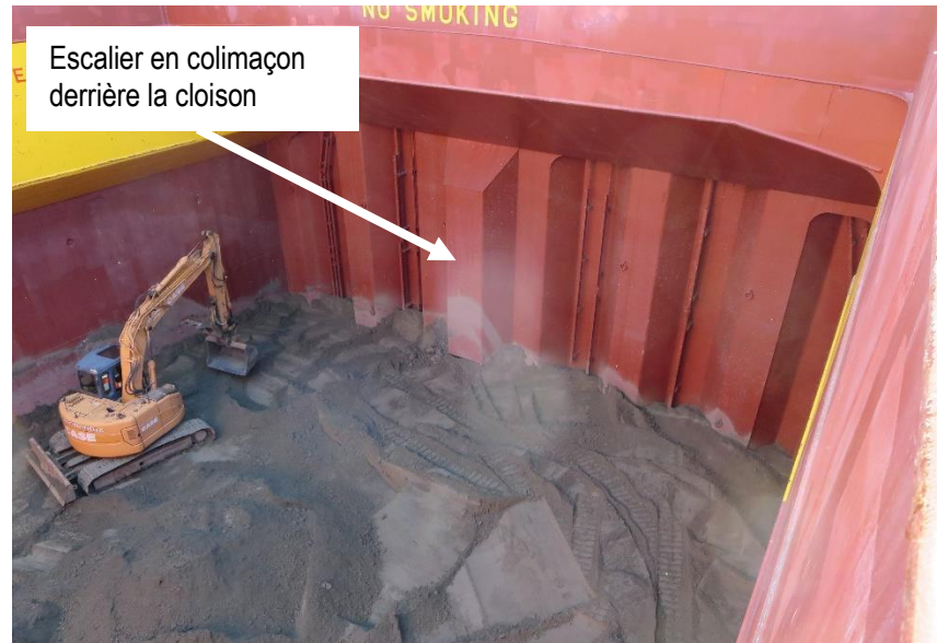
Figure 10 : Vue de la cale n° 5, l'escalier en colimaçon est derrière la cloison (source CNESST)
