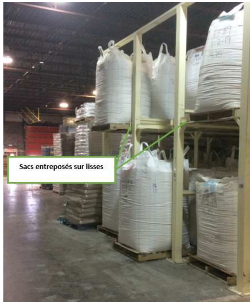
Figure 4 : Entreposage sur lisses (Source : CNESST)
