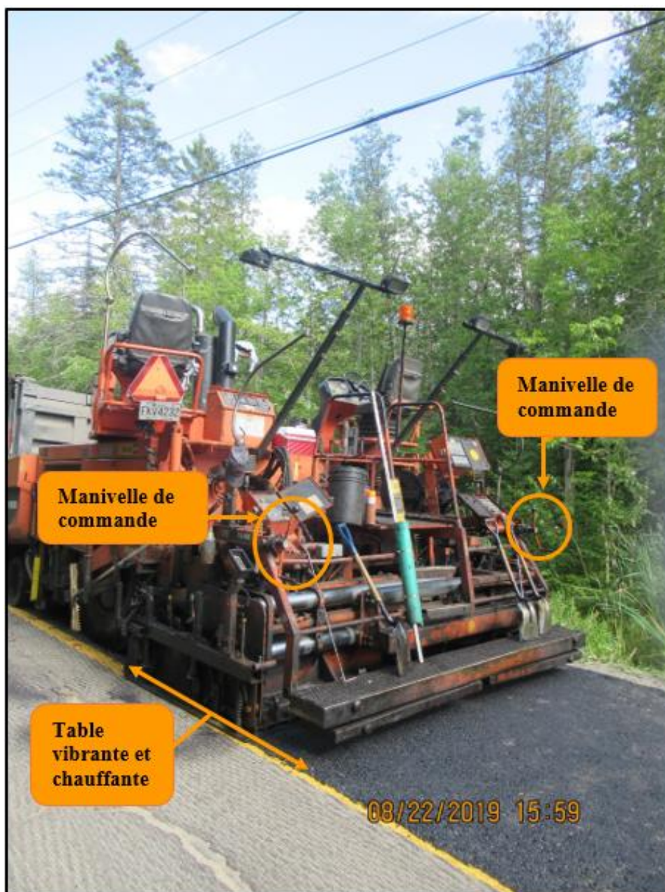
Photo n°12 : Table vibrante et chauffante CAT 10-20B du finisseur
