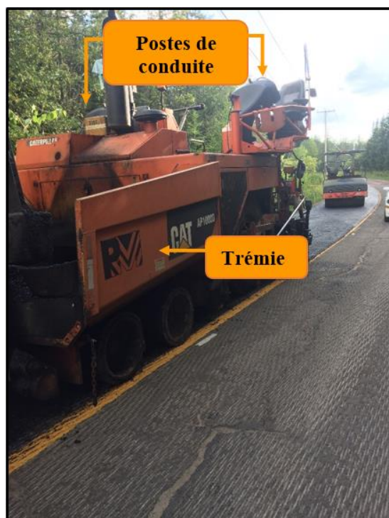
Photo n°11 : Finisseur Caterpillar AP-1000D (Source : CNESST)
