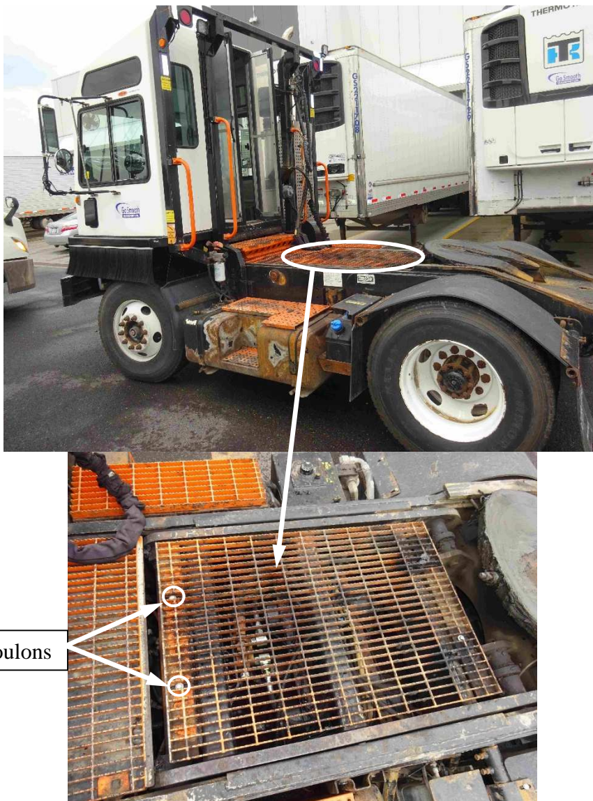
Photos 8 et 9 : Grillage recouvrant des composantes hydrauliques de la sellette
