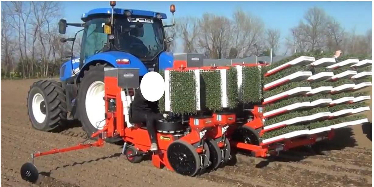
Figure 17 : Planteuse Checchi & Magli Trium 45 avec réserve et marque sillon (source : <https://www.checchiemagli.com/>)
