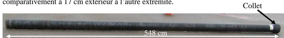
Fig. 10 — Tuyau de fonte Source : CNESST
