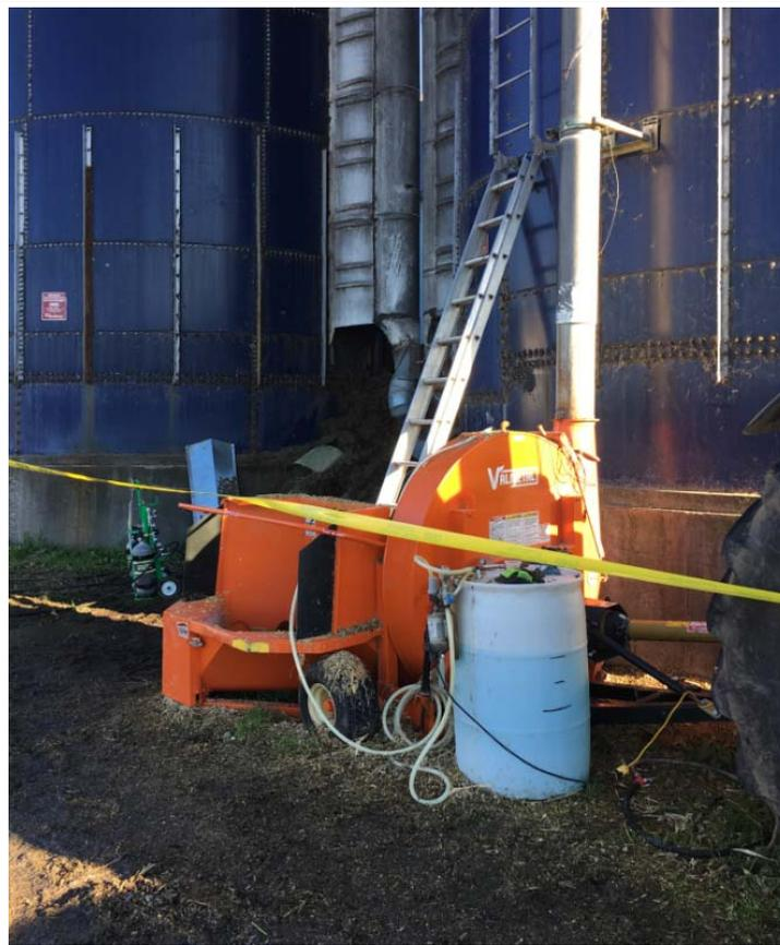
Photo 9 – Vue du ventilateur et produit injecté lors de l’ensilage
