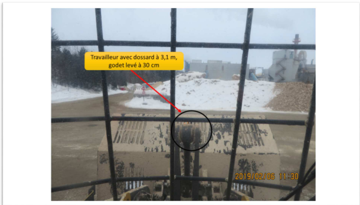
Photo 5 : Vue de l'opérateur
