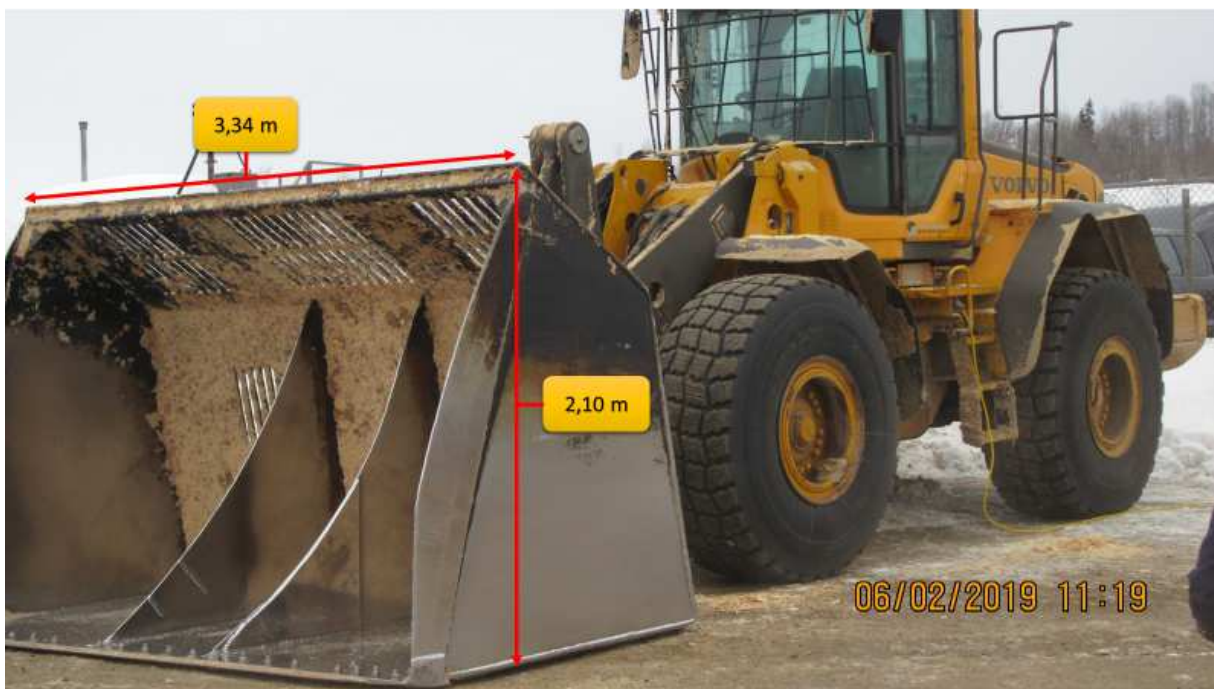
Photo 4 : Dimensions du godet de la chargeuse
