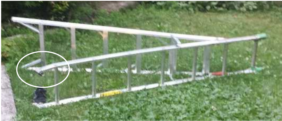
Photo 5 : Pied déformé de l'échelle transformable (Source : CNESST)
