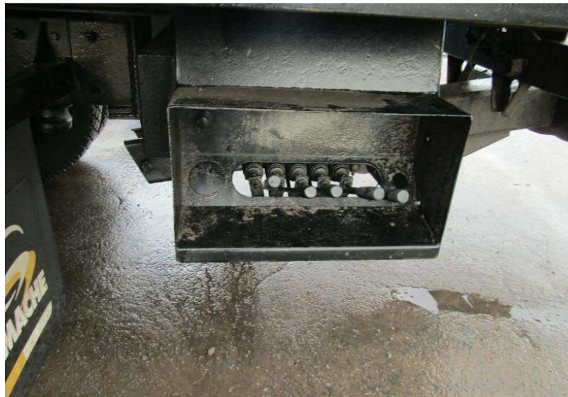
Photo 6 : Boîtier de commande de la dépanneuse à plateau Source : CNESST
