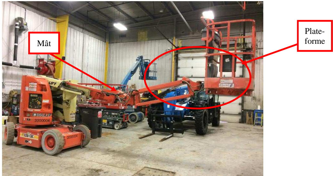
Photo 9 : Plate-forme élévatrice à bras articulé de marque JLG Source : CNESST
