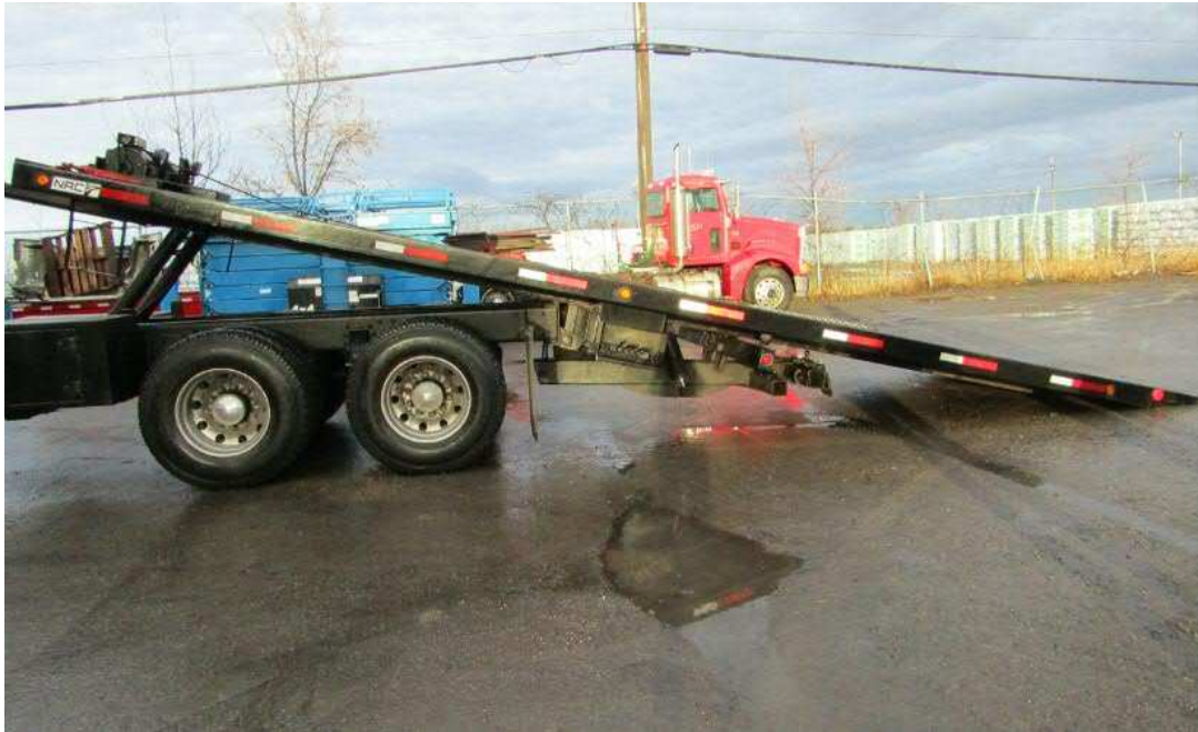
Photo 5 : Dépanneuse à plateau incliné Source : CNESST
