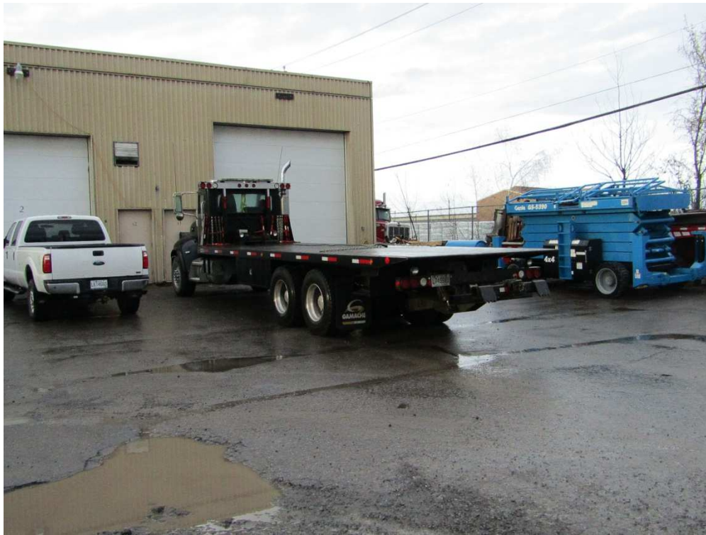
Photo 4 : Dépanneuse à plateau Source : CNESST
