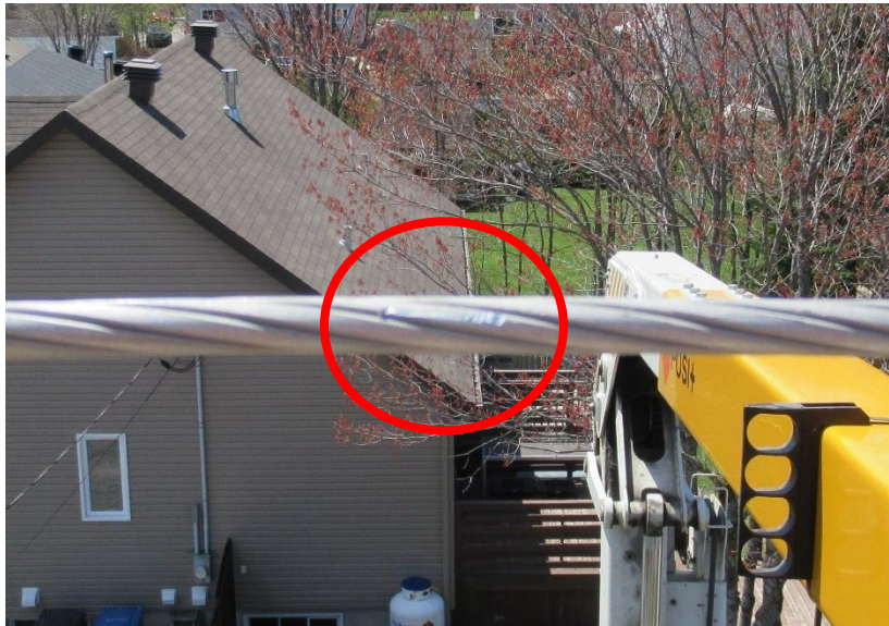
Photo 4 : Marques sur le fil électrique 14 400 V
