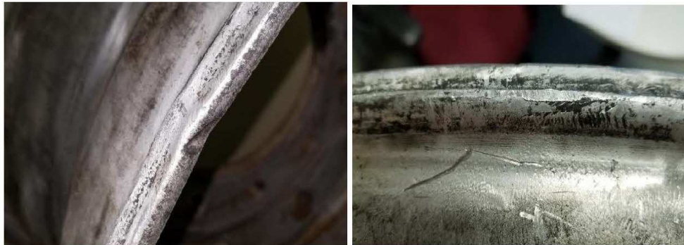
Figure 7. Déformation locale et rayure sur la surface d'installation du pneu
