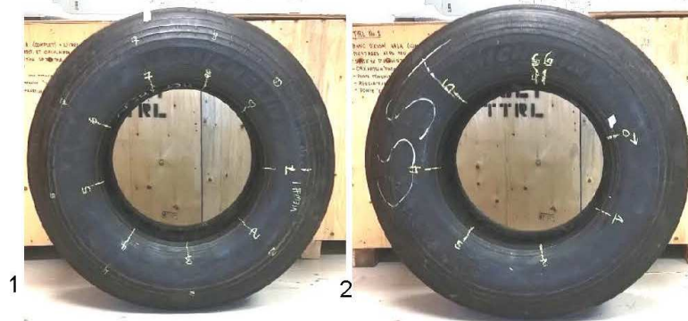
Figure A1-19. Photo du pneu face #1 divisée en 9 secteurs, face #2 en 7 secteurs
