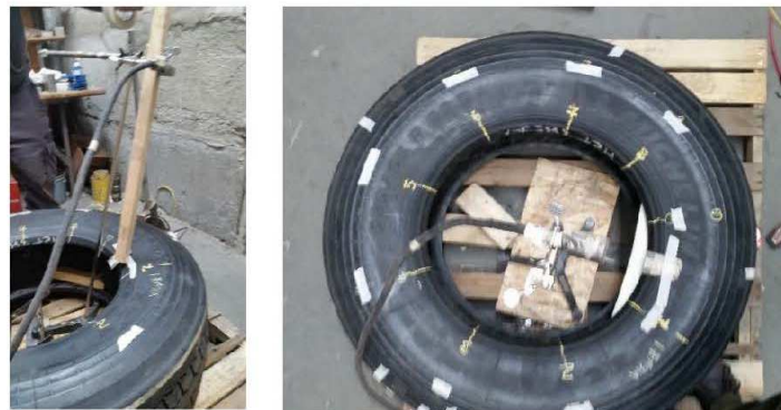
Figure A1-20. Vue de face et vue de dessus du montage pour les Rx du pneu
