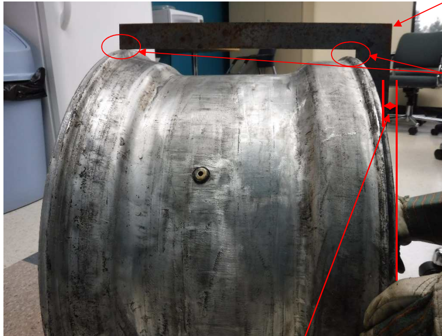
Photo 13 - Test de l'équerre selon le manuel Alcoa
