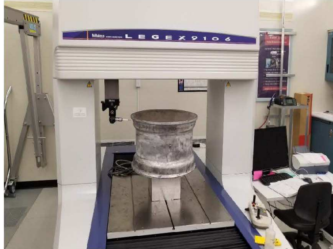
Figure 10. Jante en position de mesurage sur la machine de mesurage en coordonnées
