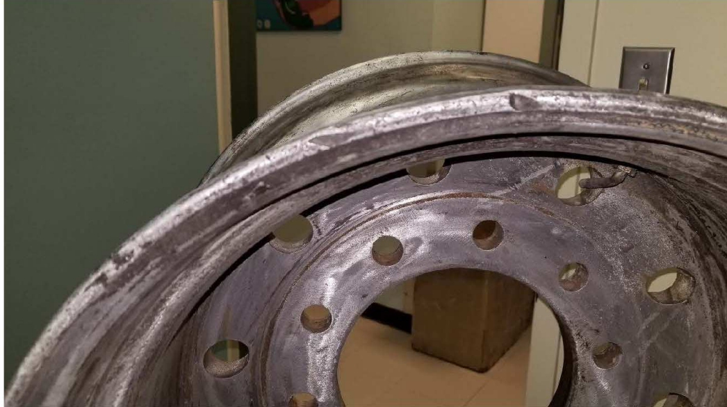
Figure 8. Aplatissement de la jante dans la zone près de la valve du côté intérieur
