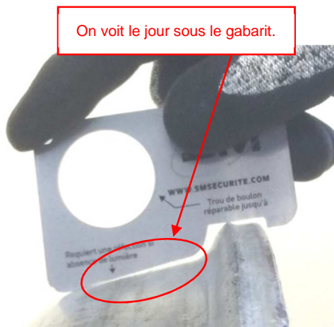
Photo 11 - Côté extérieur de la jante conforme
