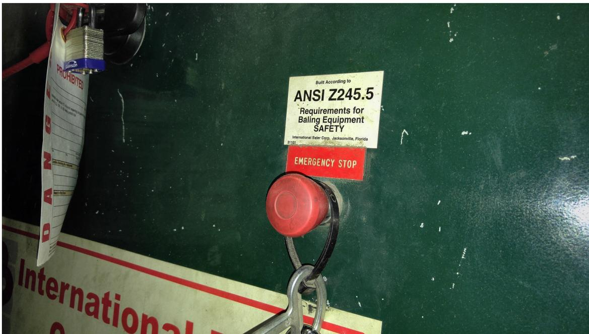
Photo M Vue avant du bouton d'arrêt d'urgence dont le bloc contact est montré à la photo L
