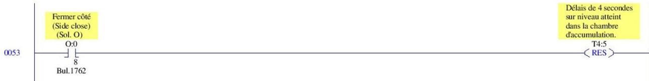
Image 6 Lignes 0053 du programme du contrôleur programmable --- Remise à zéro de la mémorisation du niveau atteint dans la chambre d'accumulation (T4 :5)
