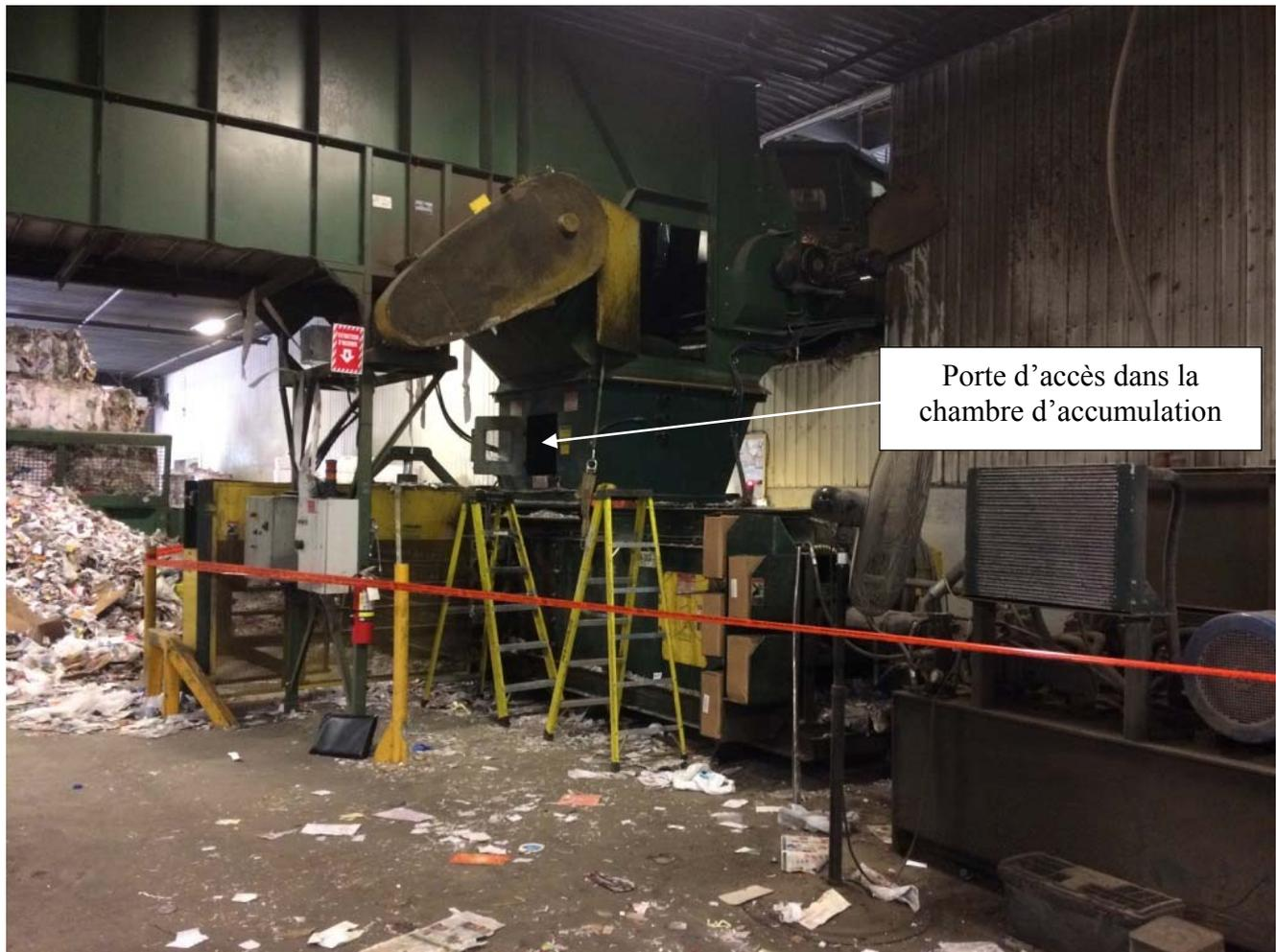
Photo n° 1 : Presse à balles horizontale dans laquelle s'est produit l'accident (source : CNESST)
