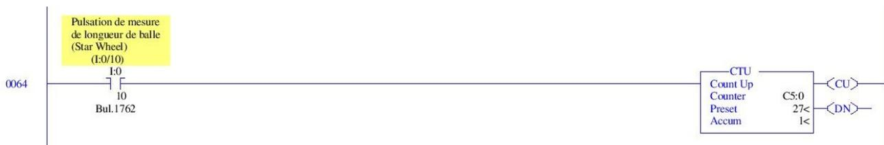
Image 13 Lignes 0064 du programme du contrôleur programmable --- Augmentation de la longueur de la balle par la roue de mesurage et le compteur C5 :0
