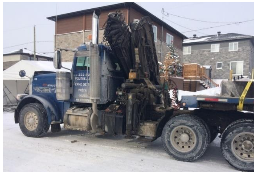
Photo 3 : Camion-grue à mât articulé Peterbilt muni de la grue Atlas 290, le 14 décembre 2017 (Source : CNESST)
