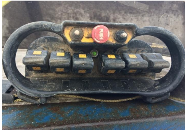
Photo 4 : Télécommande de la grue utilisée au moment de l'accident (Source : CNESST)
