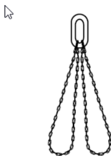
Figure 4 : Exemple de la méthode chaînes doubles en panier (Source : Gréage et appareils de levage, MultiPrevention)
