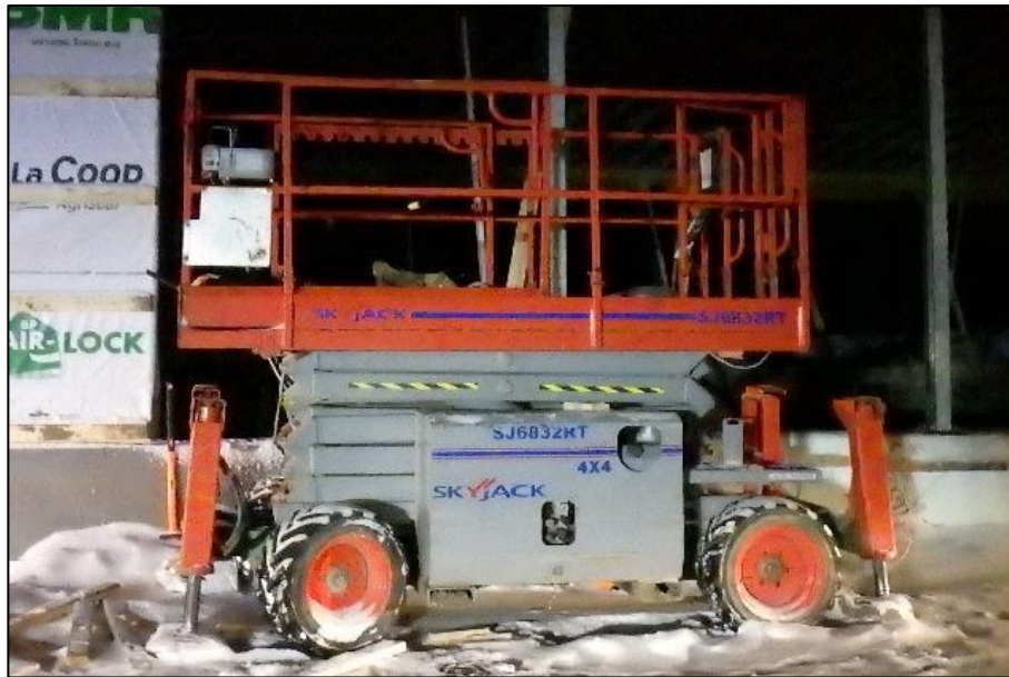
Photo 3. Plate-forme de travail élévatrice SJ6832RT impliquée dans l'accident (Source : CNESST)
